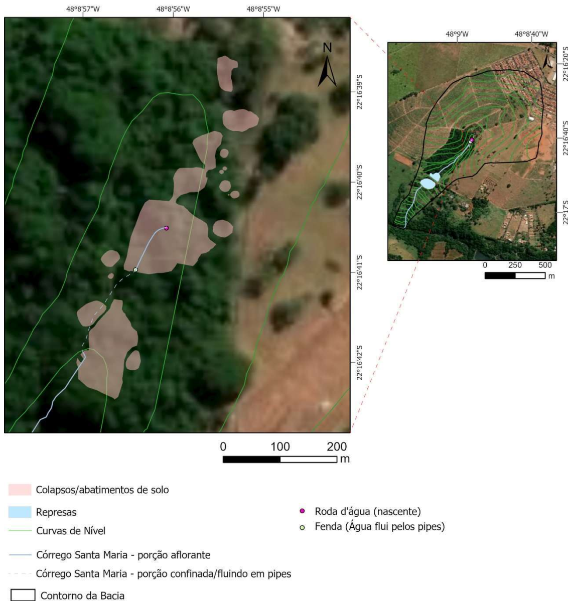
Figura 13 – Mapa preliminar dos colapsos e abatimentos.
