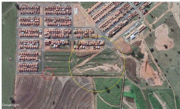
Figura 34 – Conjunto Habitacional Jardim Modelo (31 maio/2010). Em vermelho e amarelo, pontos indicando erosões lineares.
