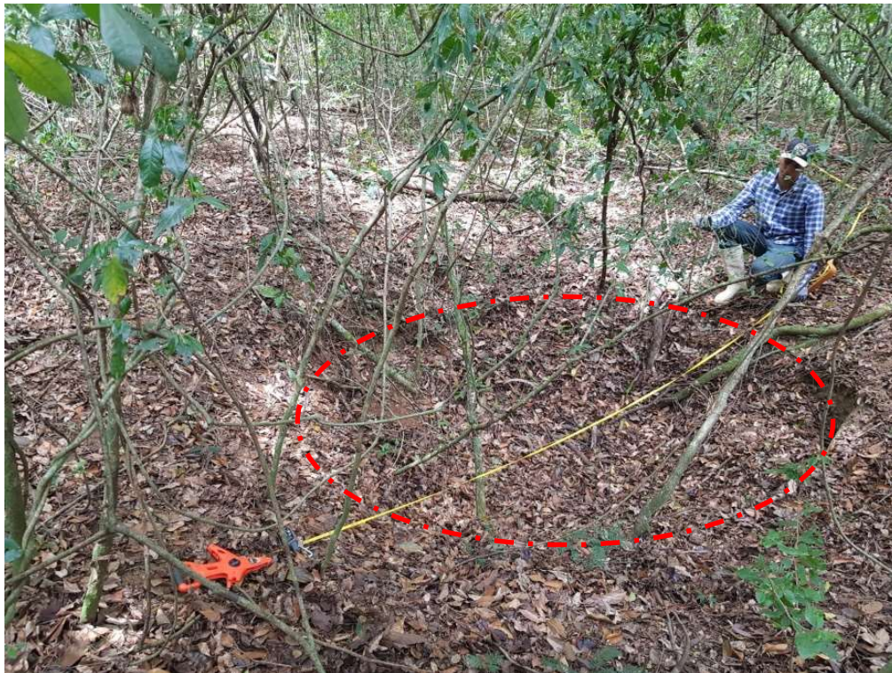
Figura 1 – Exemplo de abatimento de solo na área de pesquisa (out./2019).
