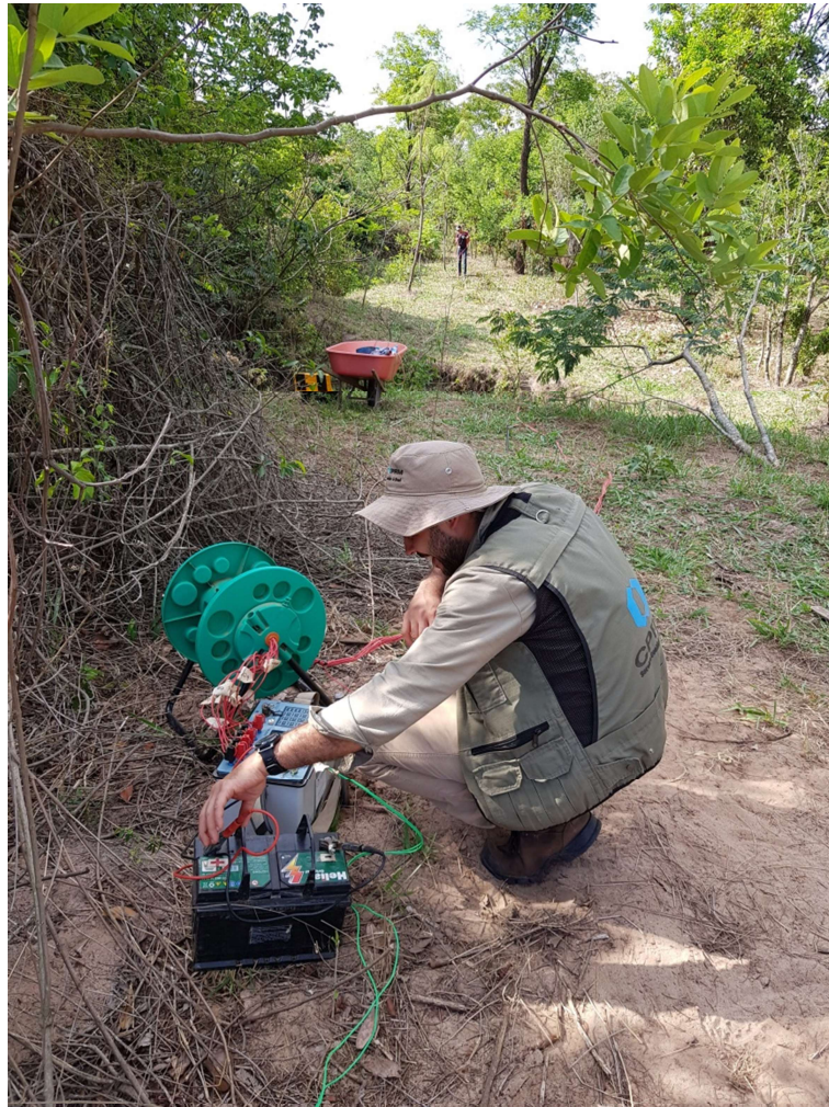
Figura 63 – Caminhamento elétrico da linha 3.
