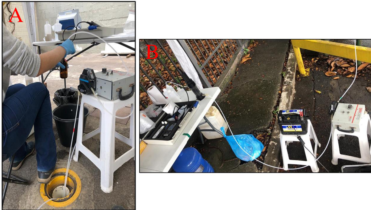
Figura 34 - Metodologia aplicada na amostragem de poços do tipo CMT (Figura A) e poços convencionais (Figura B). Notar a utilização de célula de fluxo durante a estabilização dos parâmetros físico-químicos na Figura B (poços convencionais) e sua ausência na amostragem do poço do tipo CMT.
