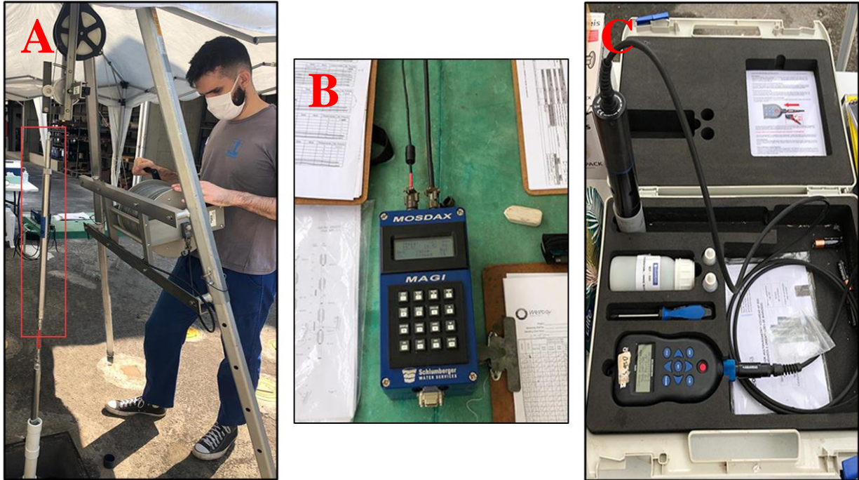
Figura 32 – Equipamentos utilizados na amostragem de águas subterrâneas no poço tipo Westbay. A: Tripé e sonda amostradora (destacado em vermelho), B: Controlador MAGI, e C: Sonda multiparâmetros YSI Professional e Aquaread.
