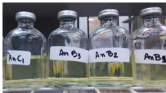
Foto 22 – Microcosmos anaeróbios (An), com alíquotas das réplicas dos microcosmos C e B
