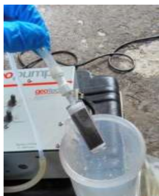
Foto 5 – Filtração de amostra do CMT-07, com bomba peristáltica e filtro sterivex®
