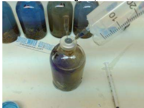
Foto 14 – Adição de resazurina e água ultrapura MiliQ® no controle negativo, em laboratório
