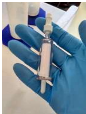
Foto 5 – Filtração de amostra do CMT-07, com bomba peristáltica e filtro sterivex®
