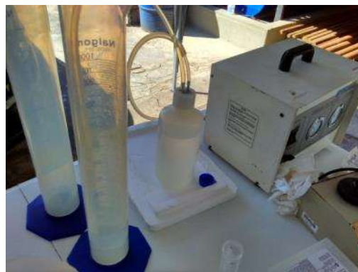
Foto 2 – Teste de filtração de amostra em campo
