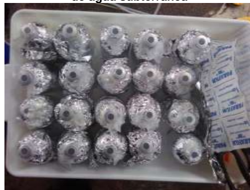
Foto 14 – Adição de resazurina e água ultrapura MiliQ® no controle negativo, em laboratório
