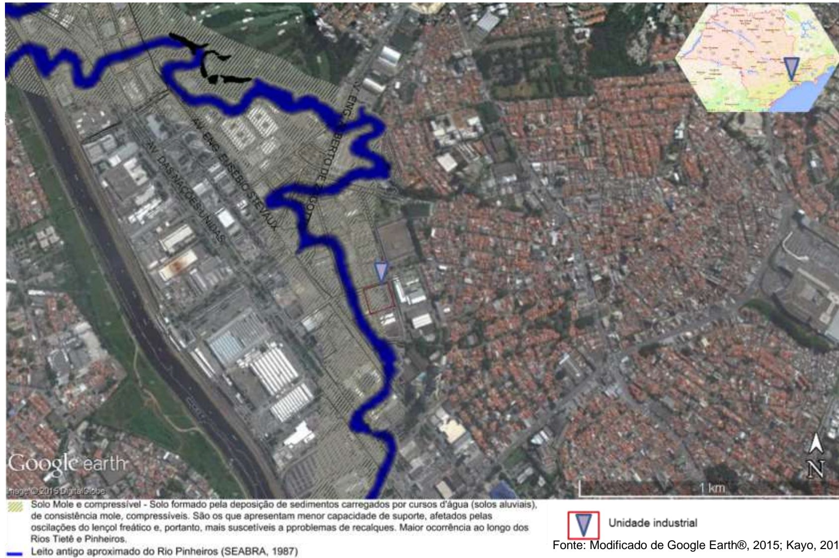
Figura 3.2 – Localização da unidade industrial, na área crítica do Jurubatuba, com sobreposição do traçado original do Rio Pinheiros e extensão de solos aluviais
