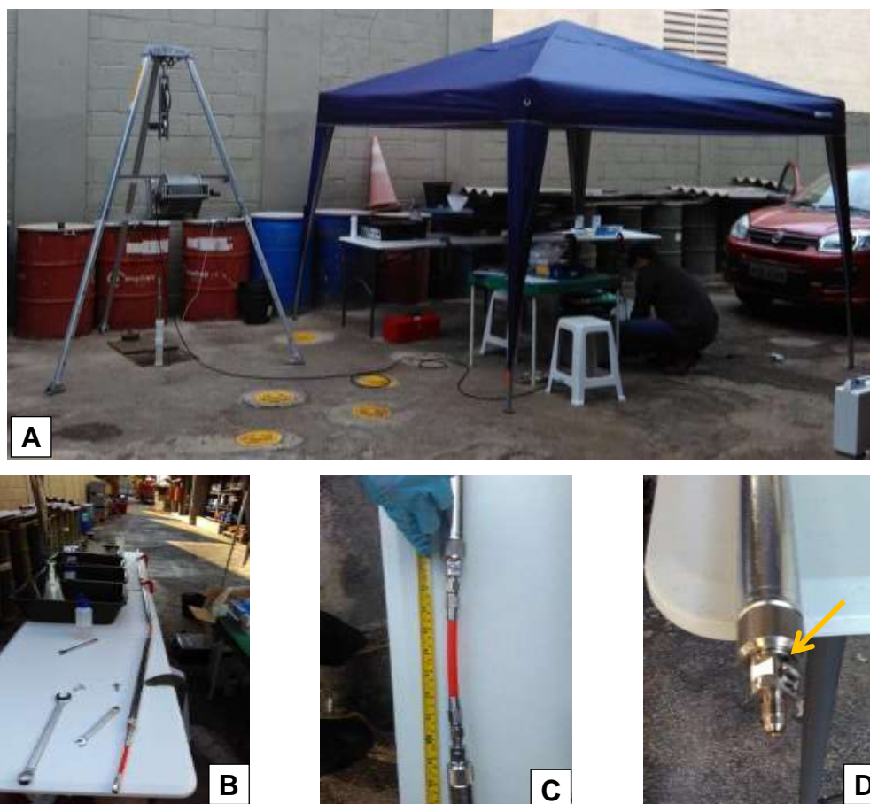
Figura 4.7 – Canisters para amostragem do poço Westbay® MP-01
