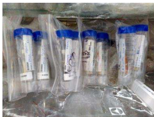
Foto 6 – Filtros identificados com volume filtrado e ponto de coleta, mantidos no gelo
