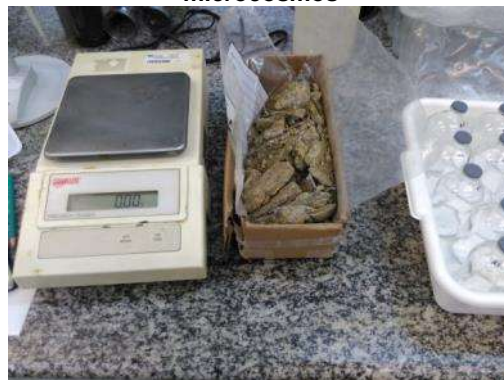
Foto 10 – Adição do sedimento nos frascos de penicilina
