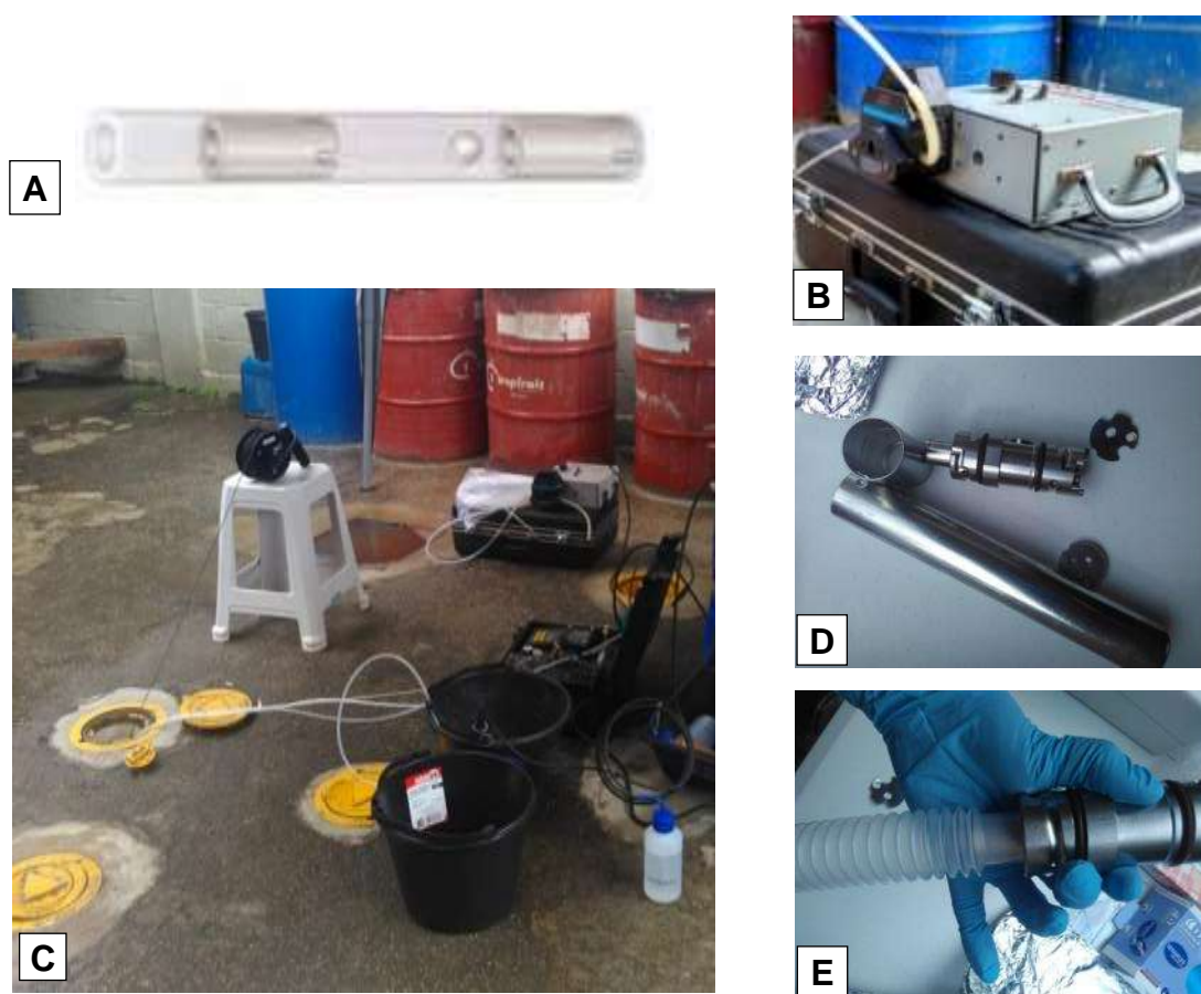
Figura 4.8 – Equipamentos utilizados na amostragem de água subterrânea: mini bomba inercial de inox, bomba peristáltica e bomba de bexiga
