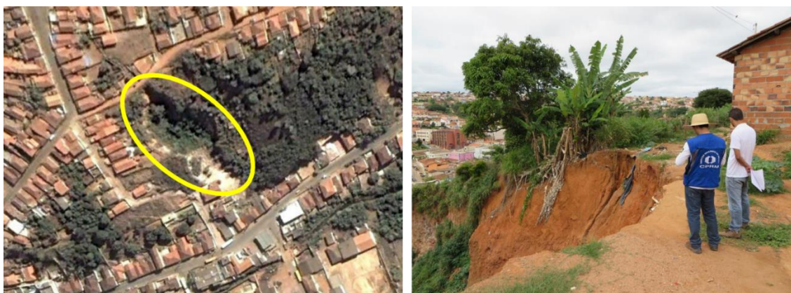
Figura 22 - Voçoroca com margens habitadas identificada na etapa de fotointerpretação (Lana et al. , 2021).
