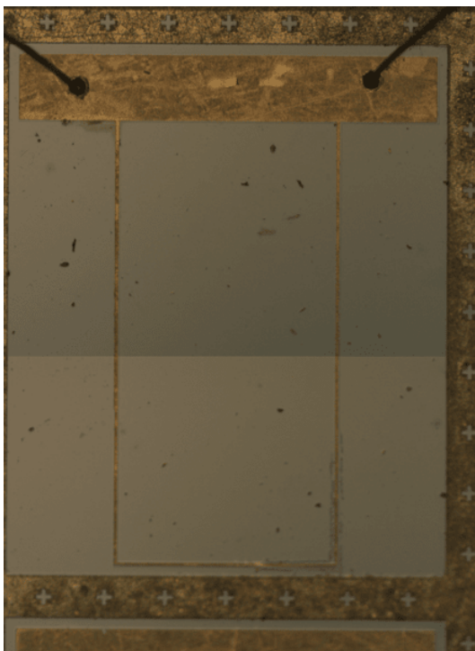
Figura 34 – Imagem de microscopia óptica de uma das células solares produzidas neste trabalho. A região cinza delimita a área do dispositivo. A mudança dos tons de cinza é um artefato decorrente da imagem ser formada por duas capturas diferentes combinadas. As partes amarelas são os contatos. Os dois fios pretos no busbar servem para conectar a célula a um chip carrier para medidas de eficiência quântica.
