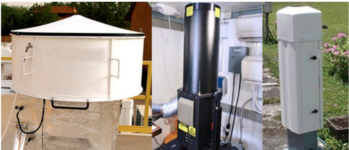
Figura 17 - Instrumentos utilizados para obtenção de CBH e CTH no T3. O intervalo de amostragem foi de 5 s. Da esquerda para a direita: Radar de nuvens (WACR), LIDAR de micropulsos (MPL) e Ceilômetro (CEIL). Fonte: ARM.
