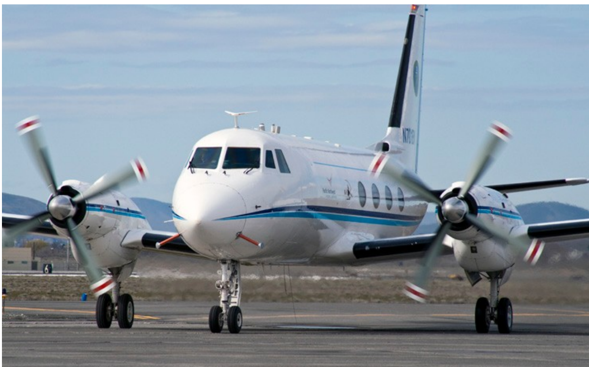
Figura 10 - Avião Gulfstream-159 (G-1), utilizado pelo ARM entre 2009 e 2018 para obter medidas de diversas variáveis atmosféricas ao redor do globo. Imagem disponível em < https://www.arm.gov/capabilities/observatories/aaf/manned >. Último acesso em 17/05/2023.
