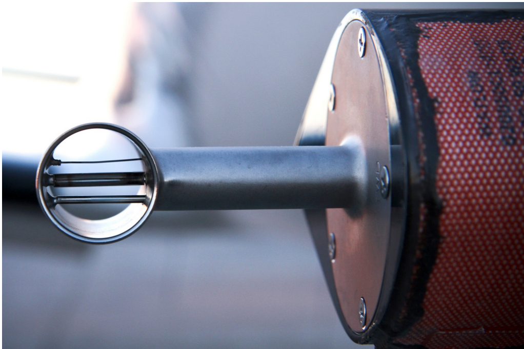
Figura 13 - Sensor WCM-2000, que mediu valores de LWC e TWC. Foto obtida pela pesquisadora Jennifer Comstock, responsável pela manutenção do instrumento e pela curadoria dos dados obtidos pelo WCM-2000 durante as IOP's 1 e 2.
