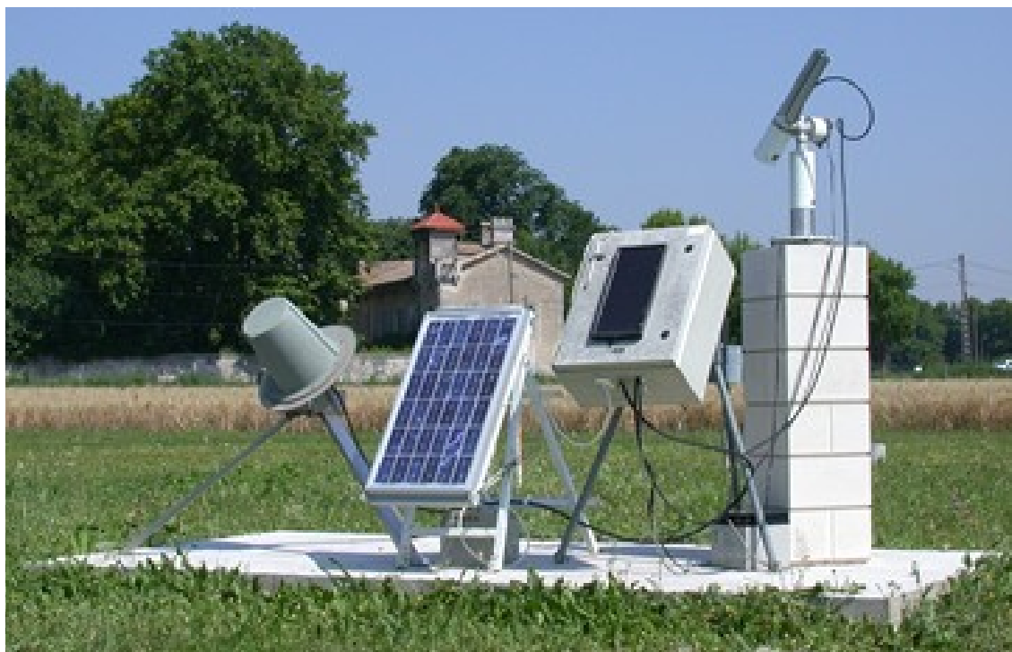
Figura 19 - Fotômetro solar da rede AERONET. Fonte: < https://aeronet.gsfc.nasa.gov/new_web/system_descriptions.html >. Último acesso em 23/05/2023.
