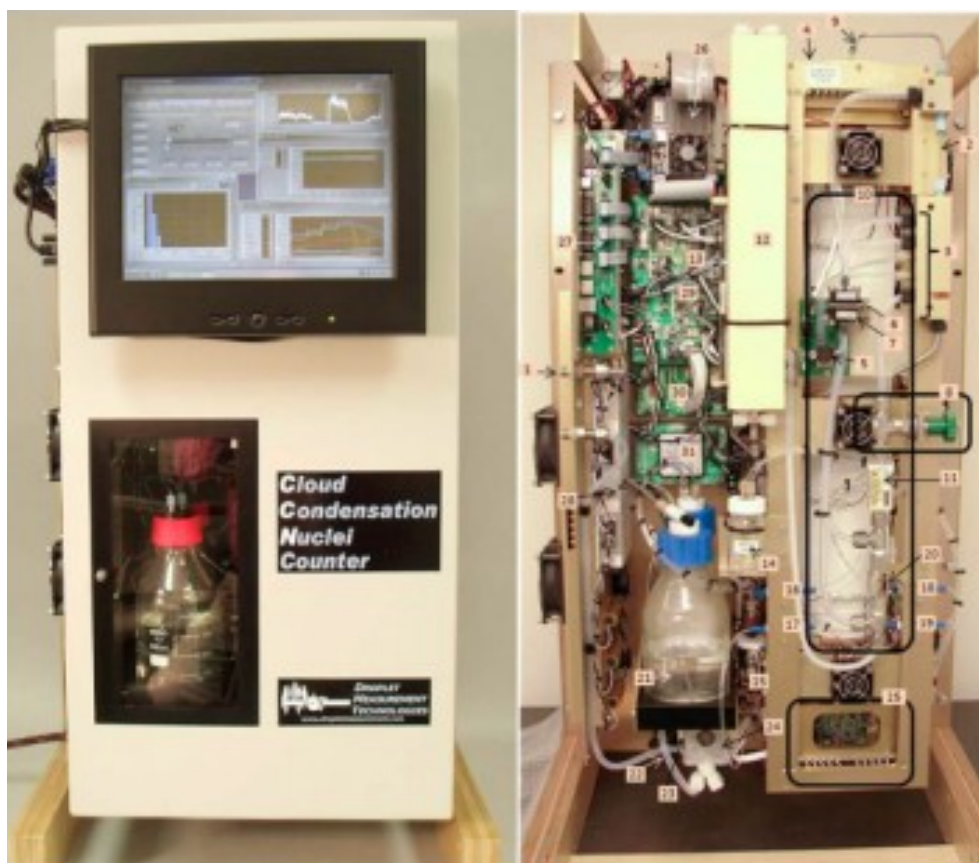
Figura 20 - CCNPC-100 operacional (esquerda) e aberto para manutenção (direita). Imagens retiradas do website ( https://dropletmeasure.wpenginepowered.com/wp-content/uploads/2020/02/DOC-0086-Rev-M-CCN-Manual.pdf ) do fabricante do aparelho.
