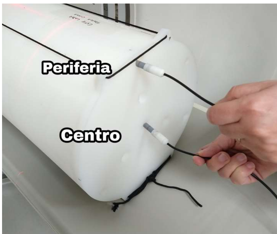
Figura 10. Câmaras de ionização foram inseridas nos orifícios central e periférico do objeto simulador. Figura de autoria própria.
