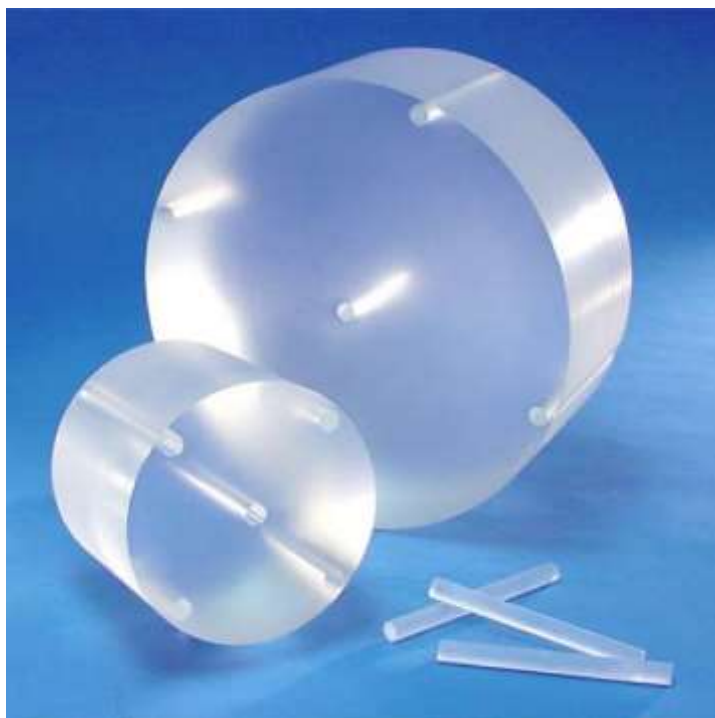
Figura 1. Objeto simulador de CTDI. São realizadas medições em dois objetos simuladores diferentes: para cabeça e corpo . O objeto simulador de cabeça possui 16 cm de diâmetro, enquanto o objeto simulador de corpo possui 32 cm de diâmetro. Fonte: (Oncology Medical Physics) Disponível em: https://oncologymedicalphysics.com/ct-dosimetry/ . Acesso em: 03/02/2023.
