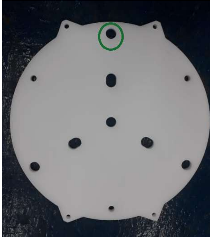
Figura 6. Placa End Cap do objeto simulador. A área selecionada em verde (no topo da imagem) é onde a câmara de ionização deve ser introduzida para medição no eixo periférico. Fonte: Marcos Santos de Souza.
