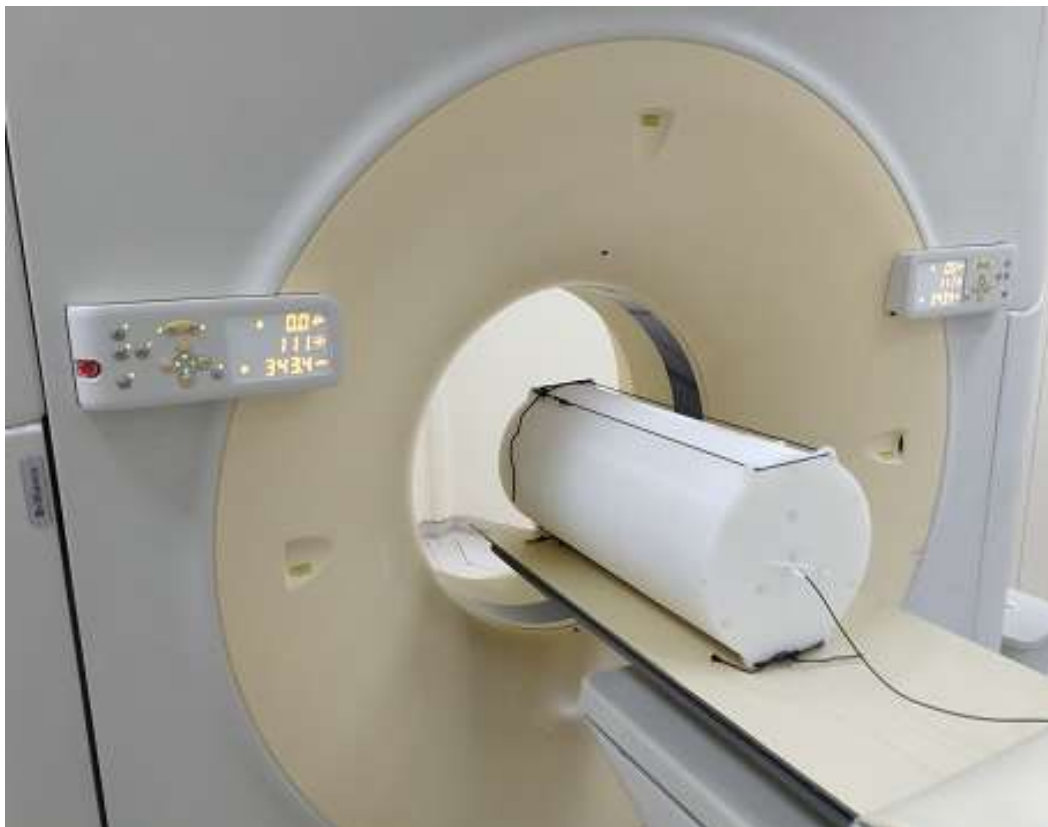
Figura 9. Objeto simulador ICRU/AAPM sob a mesa de um tomógrafo. Figura de autoria própria.
