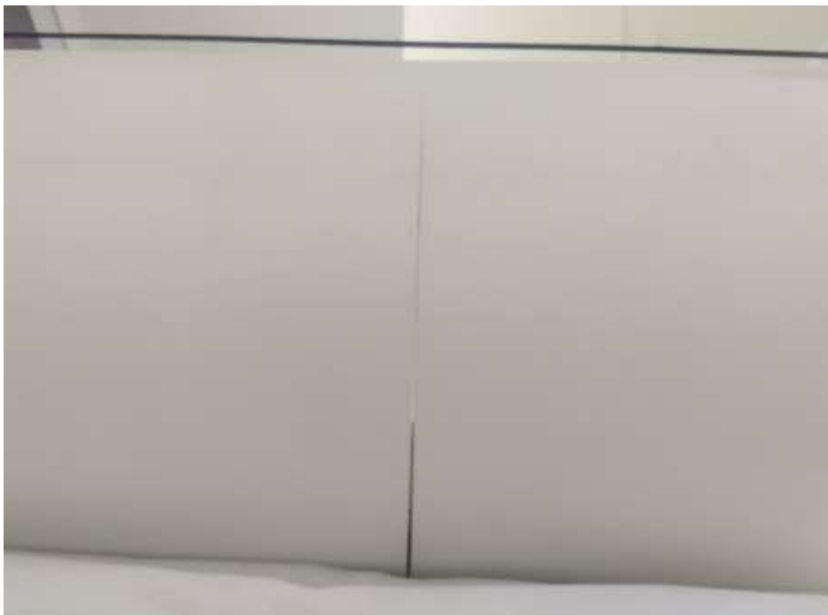
Figura 7. Lacuna entre as seções do objeto simulador. Figura de autoria própria.
