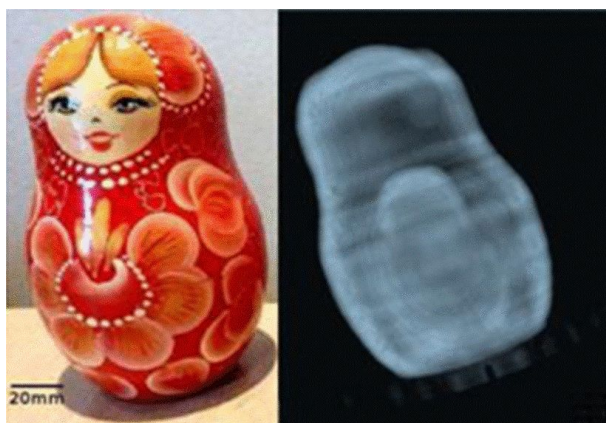
FIGURA 2.12 Tomografia terahertz computadorizada de Matriochkas. Imagem extraída de [103] ( Open access ). Copyright © 2011, Optical Society of America .
