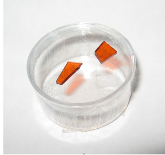
Figura 3.1: Amostras epitaxiais de EuTe crescidas em substrato de BaF 2 .
