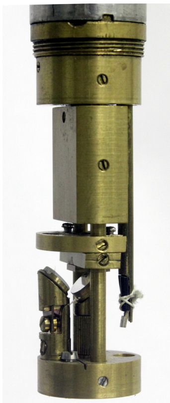
Figura 3.8: Porta-amostra utilizado na espectroscopia de absorção.
