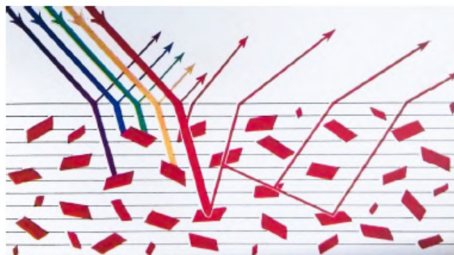
Figura 3.4 - Esquema ilustrativo da absorção, refração e reflexão (externa e inteira) de um feixe policromático por um material (WRIGHT, 1958).
