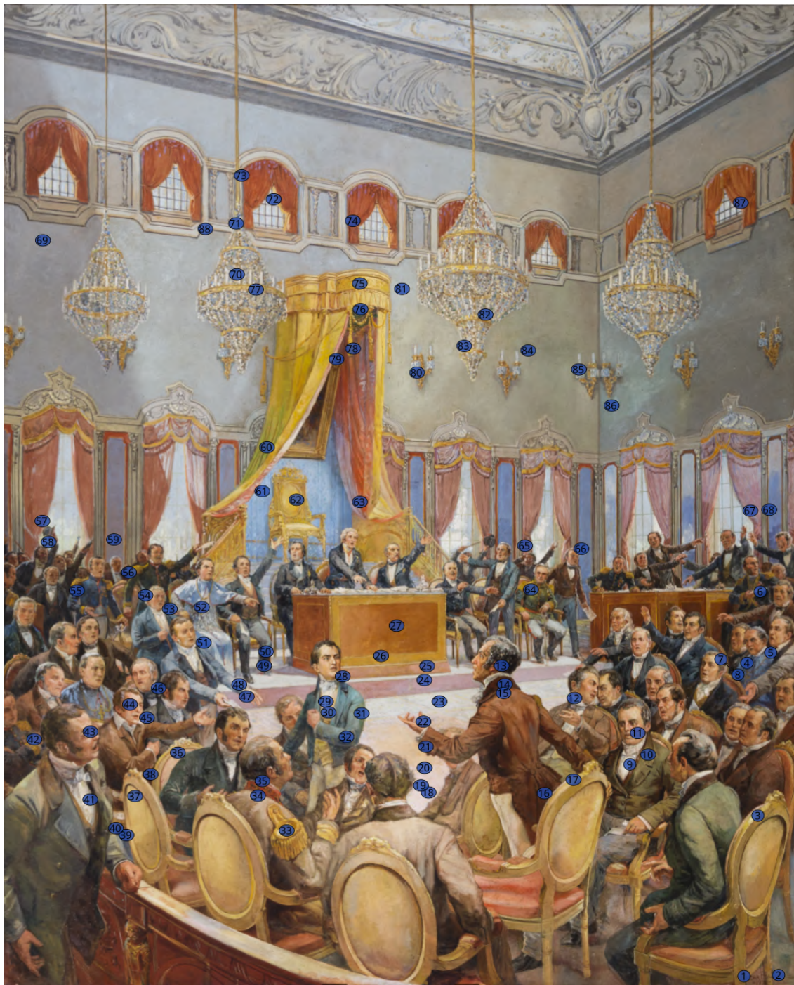
Figura 5.79 - Imagem VIS com a identificação dos pontos selecionados para medições espectroscópicas FRX e Raman sobre a obra “Sessão das cortes de Lisboa”, pintada por Oscar Pereira da Silva em 1922. Acervo do Museu Paulista.
