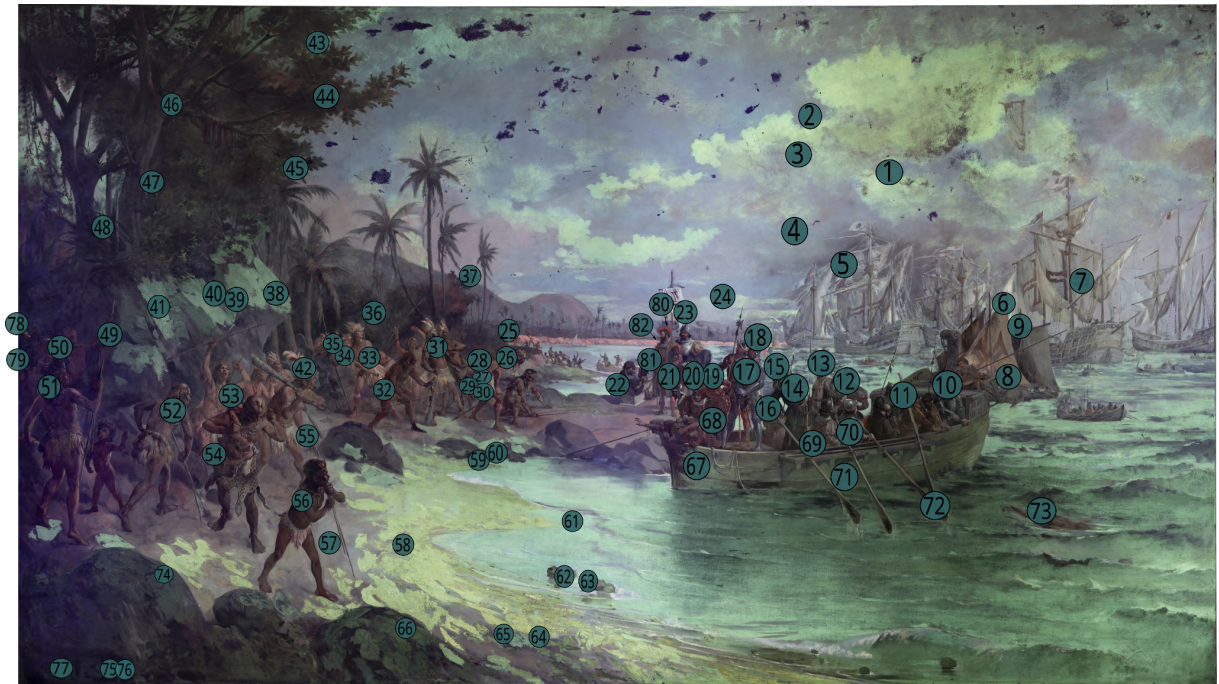
Figura 5.14 - Imagem de UV-Vis com a identificação dos pontos selecionados para medições espectroscópicas FRX e Raman sobre a obra “Desembarque de Pedro Álvares Cabral em Porto Seguro em 1500”, pintada por Oscar Pereira da Silva em 1900. Acervo do Museu Paulista.
