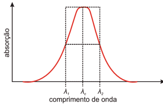
Figura 25 – Largura à meia altura da resposta espectral do fotodetector, de onde os limites de integração para o cálculo de P são obtidos.
