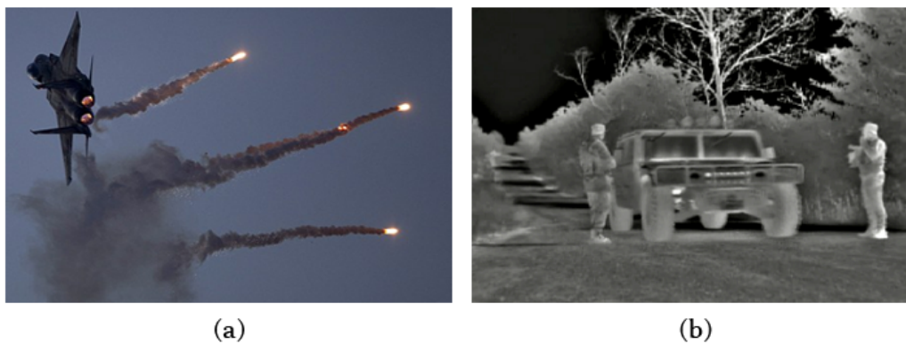
Figura 10 – (a) Flares sendo lançados por caça para enganar míssil que o persegue. (b) Soldados e veículo observados por uma câmera IR em ambiente noturno.
