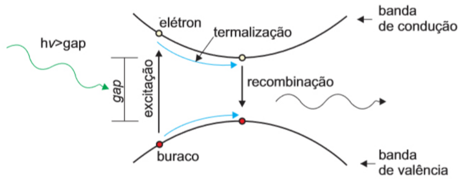
Figura 21 – Processo de geração e recombinação do par elétron-buraco (4)
