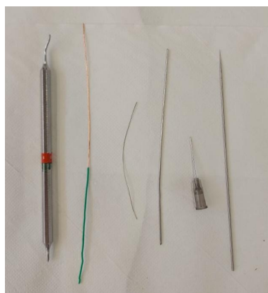
Figura G.4: Exemplo de hastes metálicas para inserção de amostra de pó nos capilares.
