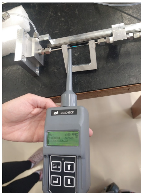
Figura G.10: Exemplo do sensor de Hélio para detectar vazamento no circuito. Para utilização é necessário calibrá-lo e deve-se usá-lo sempre na horizontal. Ele detecta 1 parte em 10.000 e deve-se aproximá-lo das conexões nos circuitos.
