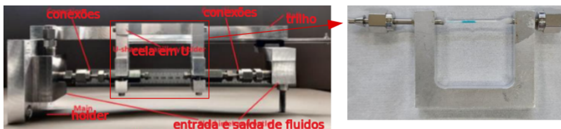
Figura G.1: Esquema do trilho em alumínio (à esquerda) que acopla a cela de reação com capilar (à direita). Através dele são ligadas mangueiras que permitem a passagem de fluidos (gases ou líquidos) por entre a amostra. Imagem adaptada do manual desenvolvido pelo doutorando do grupo Paineira Felipe Dias Faglioni.
