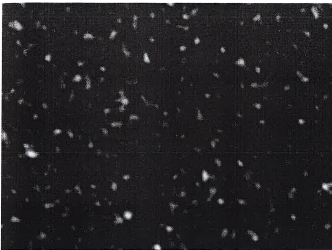
Imagem 6.2 - Imagem do padrão de speckle com ângulo de incidência \theta = 22,5^\circ e deslocamento angular igual a 100 minutos.
