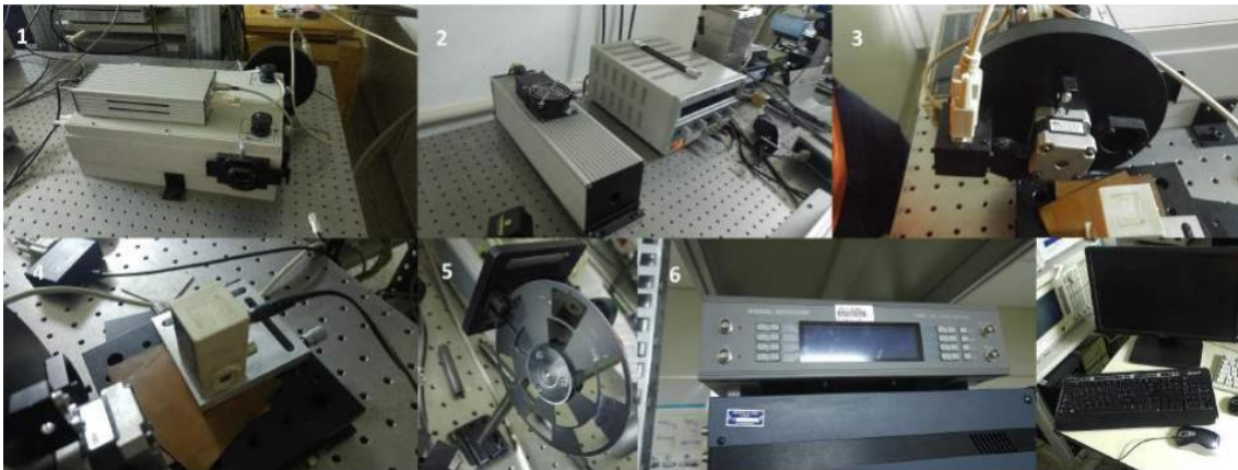
Figura 89: Arranjo experimental do experimento de absorção. 1 - Monocromador; 2 - Fonte de radiação infravermelha (“globar”) que em nosso caso foi substituída por uma lâmpada halógena que possui um espectro mais intenso no visível; 3 - Roda de Filtros; 4 - Sensor de silício; 5 - “Chopper”; 6 - “Lock-in”; 7 - Computador [102].
