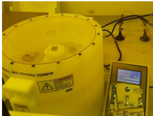
Figura 53: Spinner fechado e pronto para o funcionamento, com a amostra posicionada no centro.
