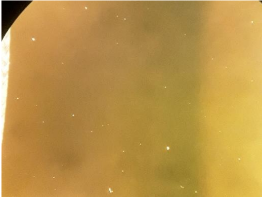
Figura 73: Imagem de uma Amostra de GaAs que recebeu as camadas de Ni, Ge e Au, antes do recozimento térmico (RTA).
