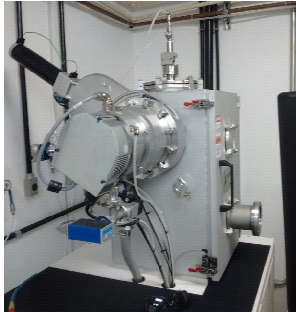
Figura 65: O sistema de deposição por feixe de elétrons, modelo Nexdep da empresa Angstrom Engineering.
