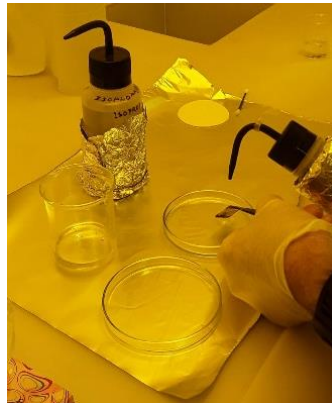
Figura 69: Lift off sendo terminado, eventualmente com cotonete, sem deixar a acetona secar.
