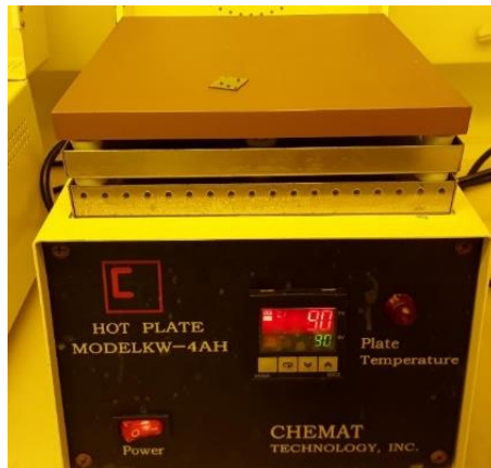
Figura 54: Placa aquecedora (“hot plate”) com a amostra 3800 a 90 °C, durante o “soft baking”.
