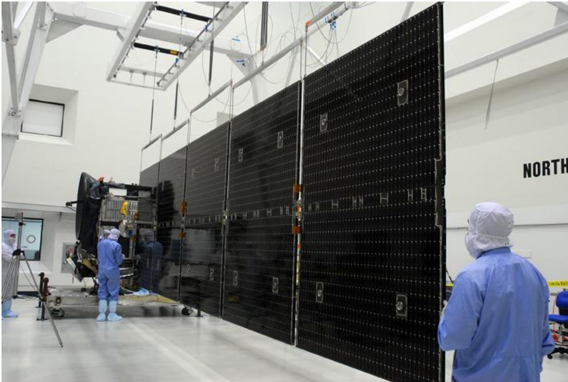
Figura 11: Sistema solar moderno da sonda espacial Dawn com potência de 5 kW [32].
