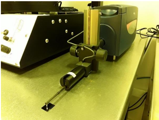
Figura 61: Perfilômetro. A amostra a ser medida está localizada abaixo da ponta de prova.
