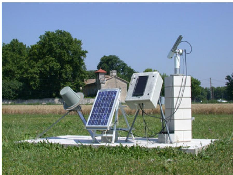
**Figura 9:** Fotômetro solar Cimel da rede AERONET (*Aerosol Robotic Network*). O fotômetro pode ser visto acima de um pedestal à direita na imagem, acompanhado de uma placa fotovoltaica, sistema de controle e antena para transmissão dos dados. *Fonte:* [https://aeronet.gsfc.nasa.gov/new\\_web/system\\_descriptions.html](https://aeronet.gsfc.nasa.gov/new_web/system_descriptions.html), acessado em 15 de fevereiro de 2021.
