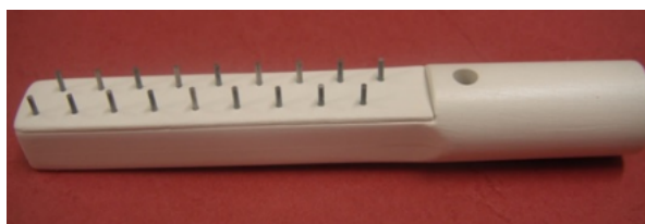
Figura 2.4: Foto da sonda de 18 pinos usada para medição simultânea do perfil radial de propriedades do plasma. Foto extraída da referência [17]
