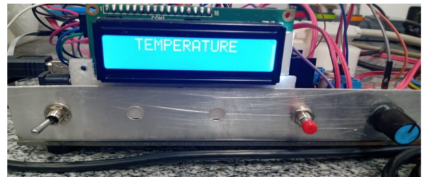
(b) Interfase para o controle da incubadora hipóxia
