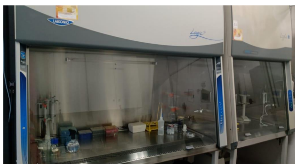
(e) Fluxos laminares utilizados para a manipulação de células e meios de cultura
