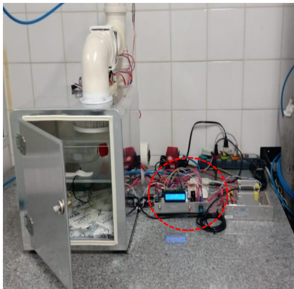
(a) Incubadora Hipóxia e circuito elétrico
