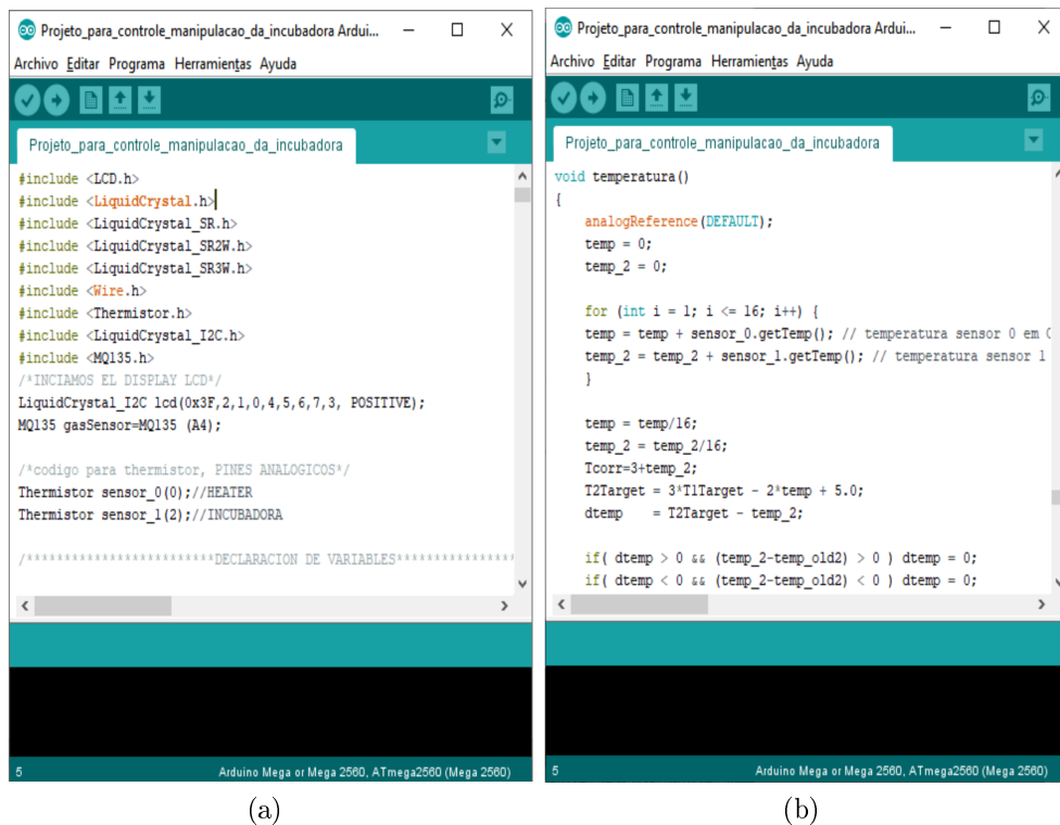
Figura 5.4: Partes do código criado para o controle e manipulação da IH no Software Arduino Mega
