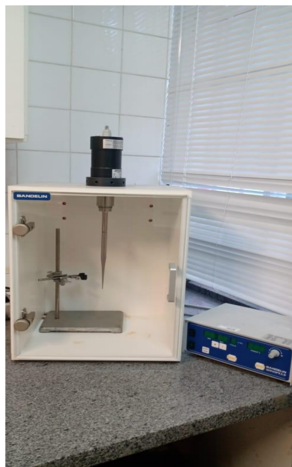
(d) Máquina de ultrassom utilizado no processo de extração metabólica
