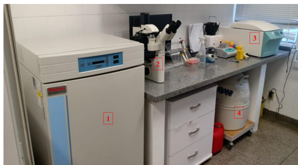
(f) 1. Incubadora comercial para cultivo de células 2. Microscópio óptico 3. Centrifuga citológica 4. Tanque de nitrogênio líquido utilizado para armazenar células congeladas
