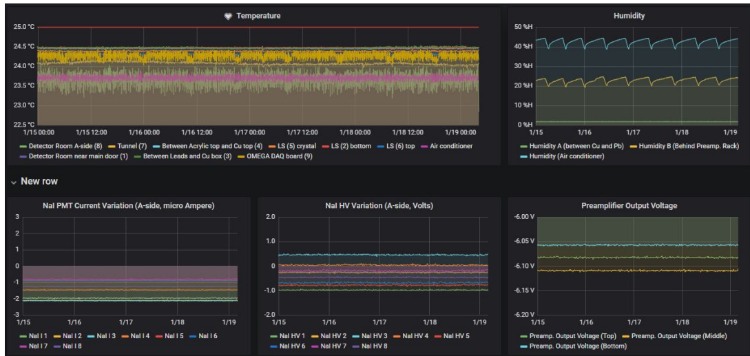
Figura 3.13: Exemplo de visualização das variáveis monitoradas pelo Grafana. A imagem mostra o status da temperatura em vários locais do detector, umidade, tensão de saída dos pré-amplificadores e variação da tensão e corrente das fotomultiplicadoras acoplada nos cristais.
