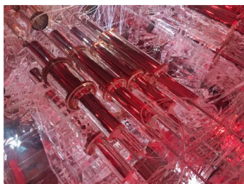
Figura 3.7: Foto mostrando os cristais. Cada cristal tem 2 PMTs acopladas em cada uma de suas extremidades. São encapsulados em cobre e por um filme reflexivo de politetrafluoretileno (PFTE).
