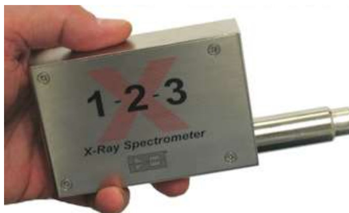
Figura 3.6 - Detector de raios X marca Amptek, modelo X-123 Complete X-Ray Spectrometer with Si-PIN Detector (AMPTEK, 2021)
