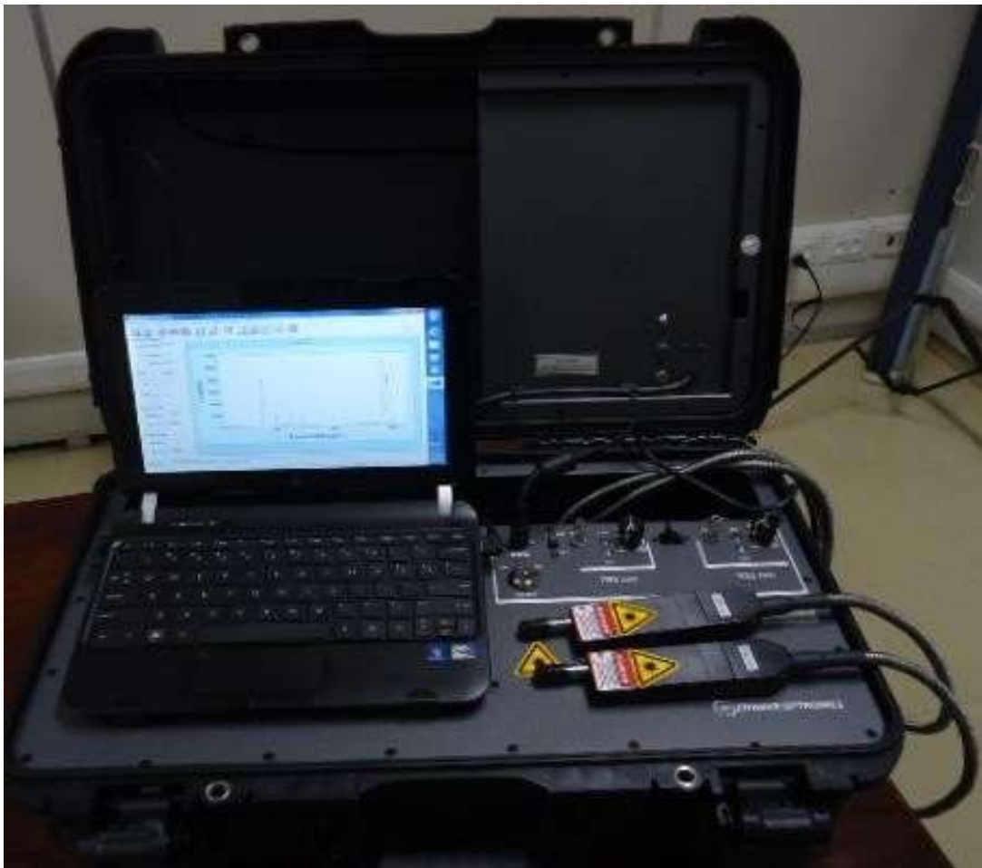
Figura 3.9 - Espectrômetro portátil marca Enwave Optronics, modelo EZRaman@-I-Dual-G-01 utilizado nas análises de espectroscopia Raman
