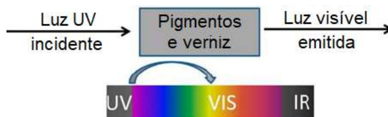
Figura 2.4 - Desenho esquemático da fluorescência visível com irradiação de luz ultravioleta. (Adaptado de COSENTINO, 2016)
