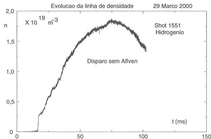
Figura 8.12: Evolução da linha de densidade da descarga de número 1551, sem o sistema Alfvén, medida ao longo de uma corda vertical a 4cm do eixo da coluna de plasma.
