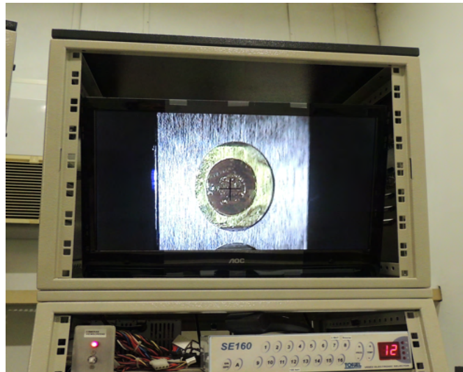
Figura 3.6: Ajuste da posição do alvo na posição de irradiação, vista no monitor da sala de controle. O disco escuro no centro do retângulo claro tem 10 mm de diâmetro e corresponde à região do alvo.
