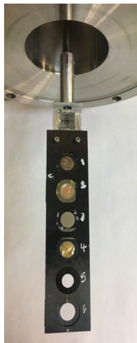
Figura 3.7: Imagem da nova torre de alvos feita de fibra de carbono, com os slots de 1 a 4 carregados com alvos diferentes, no 5, uma moldura vazada de 8 mm e o 6, com a moldura de 10 mm. A imagem do view-screen , que está acima de todos eles, pode ser vista na figura 3.8.
