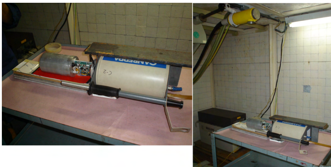
Figura 3.13: Imagens do posicionamento do detector e fonte de raios-x do IPEN.
