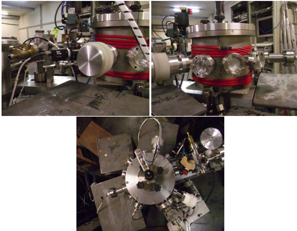
Figura 3.2: Câmara de irradiação antiga da linha de 1,9 MeV, usada para medir ionização da camada K de Au e Bi, por elétrons de 80 a 100 keV [45]. Na imagem superior esquerda, se pode ver o aparelho que filma o interior e auxilia no correto posicionamento do alvo e na focalização do feixe. Na imagem superior direita, pode se observar o beam catcher (na horizontal à direita da imagem) e os flanges. A imagem inferior é uma vista de cima.
