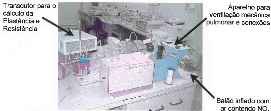
Figura 5. Sistema de coleta, análise e determinação dos índices de função pulmonar (elastância e resistência do sistema respiratório). Notar o balão de coleta do ar exalado dos ratos, contendo NO.
