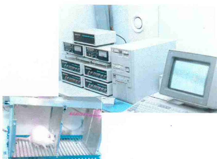
Figura 1. Equipamentos controladores das caixas de esquia ativa. Abaixo, em detalhe, rato em procedimento experimental em uma caixa de esquia.
