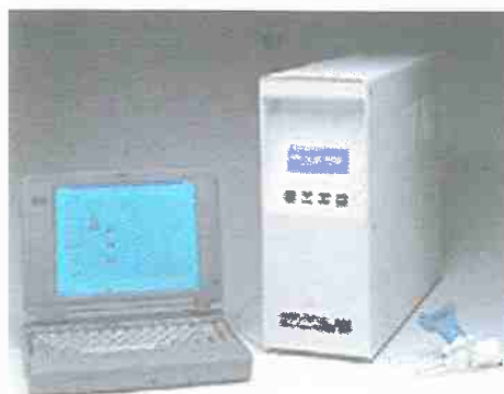
Figura 6. Aparelho de análise do ar exalado contendo NO, coletado durante o procedimento de avaliação da mecânica pulmonar.
