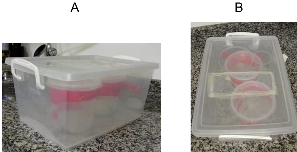
Figura 06: Dupla contenção: copos plásticos, com o filó fixados com a fita adesiva (A), armazenados dentro de uma caixa plástica fechada com uma tampa adaptada à circulação de ar e duas travas laterais (B). Fonte: IOSHINO (2018b).
