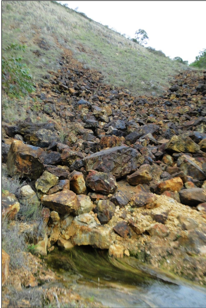
Água ácida produzida pela drenagem ácida de mina é escoada para bacia BNF.
