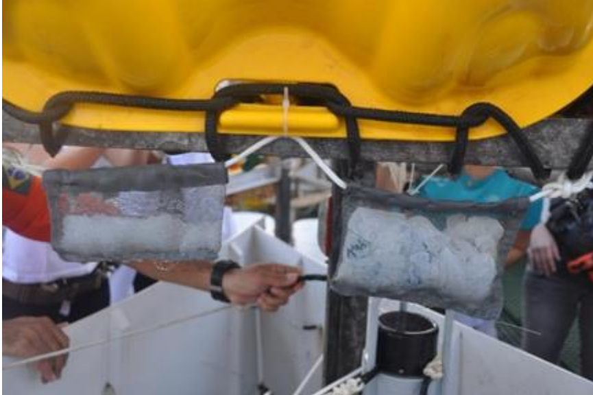
Figura 5: Sacos de fibras de vidro contendo as amostras de pellets (à esquerda) e sacolas (à direita) suspensos na estrutura do lander ..
