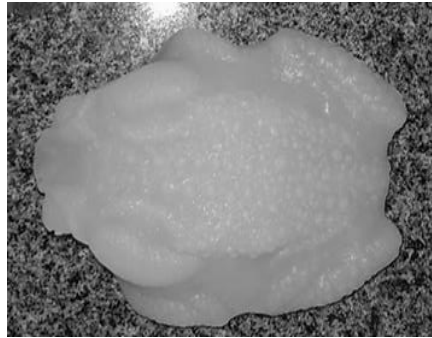
Figura 7 - Imagens fotográficas do modelo em ágar usado para estimar os efeitos da exposição aos regimes térmicos sobre a temperatura corpórea de rãs L. catesbeianus . À esquerda, detalhe do modelo equivalente a uma rã com 170 g de massa corpórea. À direita, detalhe do modelo no interior do balde, emerso sobre a plataforma, mostrando a posição dos sensores de temperatura usados no teste: um no interior de um orifício na região posterior do corpo do modelo, outro imerso na água e outro suspenso no ar próximo à superfície da plataforma.
