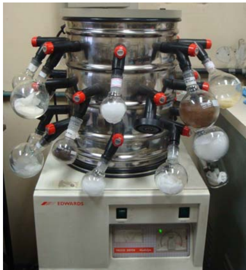
Figura 3.3. Processo de liofilização dos polissacarídeos extraídos de Gracilariopsis tenuifrons .
