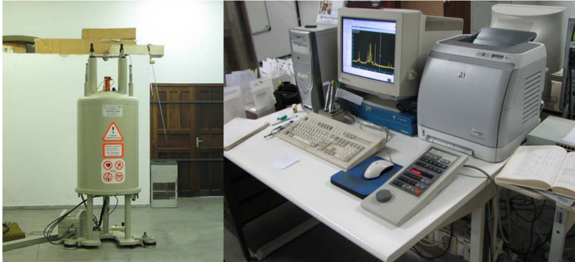
Figura 3.4. Espectrômetro Bruker, modelo DRX 400, série AVANCE, usado para obtenção dos espectros de ressonância magnética nuclear de ^{13}\text{C} e ^1\text{H} dos polissacarídeos extraídos de Gracilariopsis tenuifrons .
