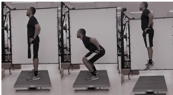
Figura 3 - Teste de salto vertical com contramovimento (CMJ)
