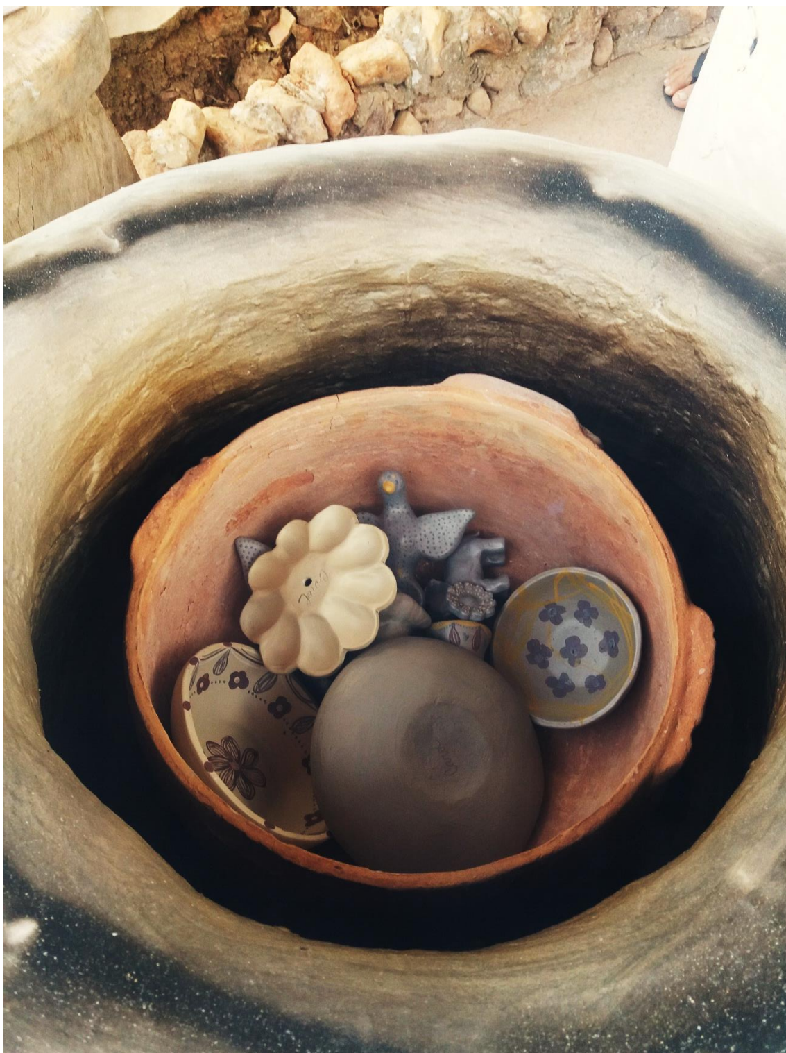
Figura 50 Forno com peças pronto para ser fechado para a queima Fonte: captada durante o trabalho de campo.
