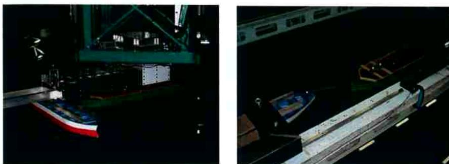
Figura 2.7: Fotografias de testes de verificação executados no NMRI. Ensaios de medição de forças em dois modelos (esquerda) e ensaios de reboque de sistema FPSO-aliviador conectados por *hawser* rígido (direita).
