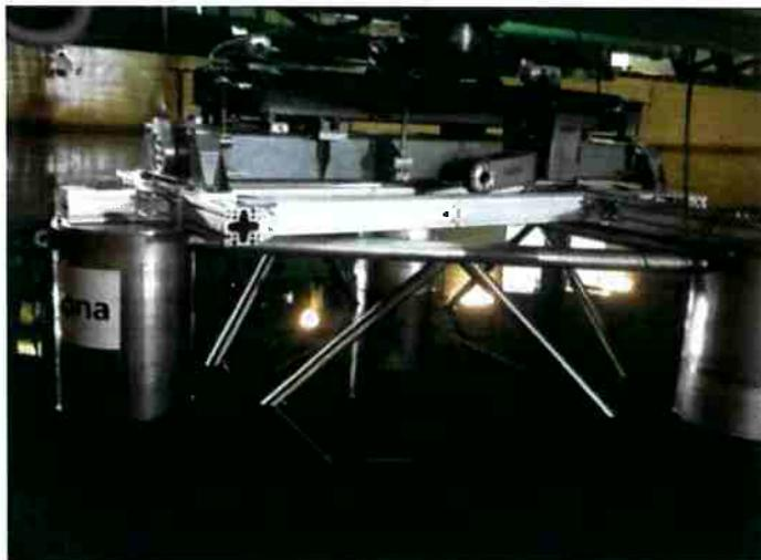
Figura 3.12: Vista de montagem do modelo da FWT para ensaios em ondas bi-cromáticas. Figura extraída de López-Pavón et al. (2013)
