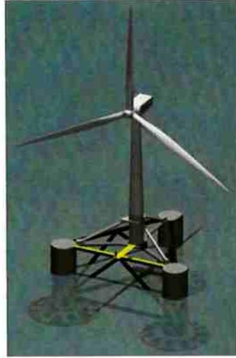
Figura 3.11: Representação gráfica da Turbina Eólica Flutuante Hiprwind. Figura extraída de López-Pavón et al. (2013)
