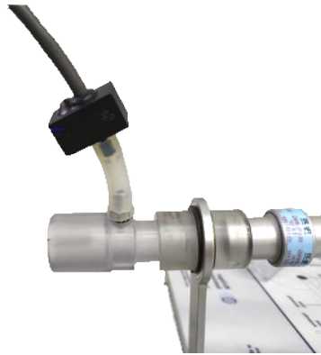
Figura 35 - Encaixe do transdutor de pressão (preto) no simulador de pulmão utilizando um adaptador
