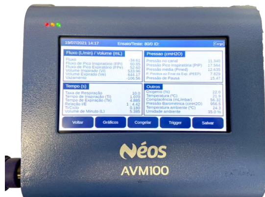
Figura 48 - Informações de fluxo, pressão, volume e tempo apresentadas em tempo real pelo AVMeC Fonte: (AVM100, Néos, Brasil)
