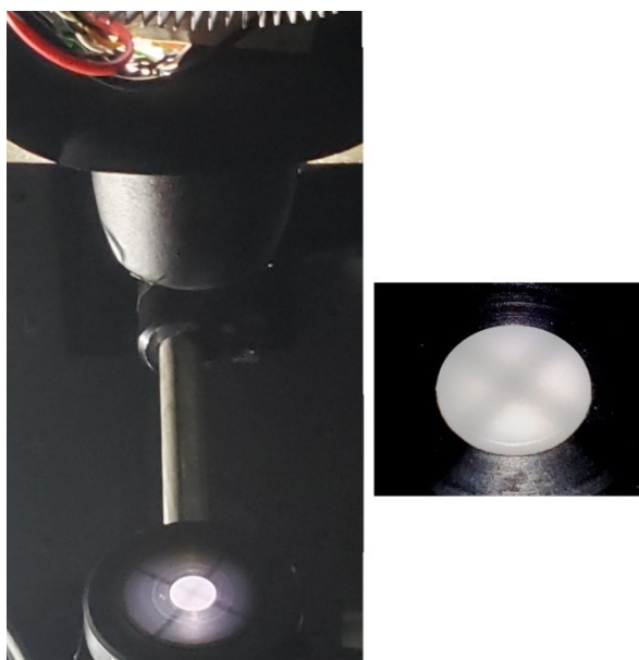
Figura 3.13 - Alinhamento da fonte LED com o dispositivo de mira e no detalhe a direita a imagem formada no detector.
