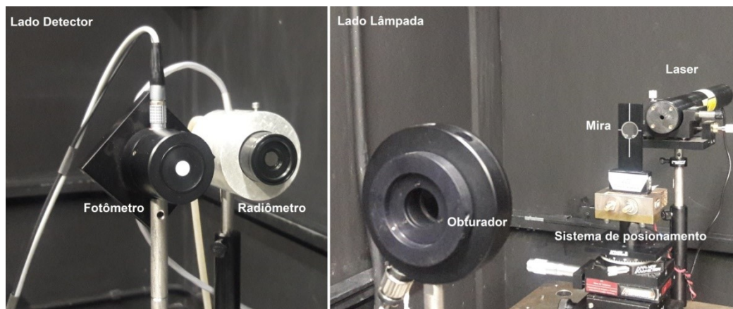
Figura 3.5 - Arranjo instrumental para sazonalização das lâmpadas nos extremos do detector e da lâmpada (os anteparados para redução da luz de fundo foram retirados). Fonte: Adaptado de Ferreira Jr. e Moraes (2017).
