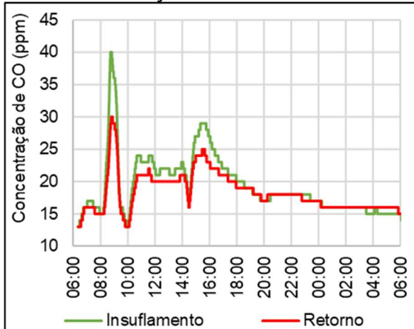
Gráfico 39 - Concentrações de CO no primeiro dia de medição de inverno na Sala A
