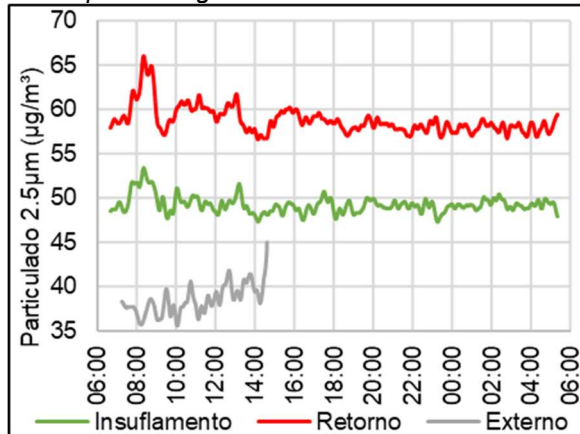
Gráfico 105 - Concentração de particulado 2.5 \mu m no segundo dia de verão na Sala F
