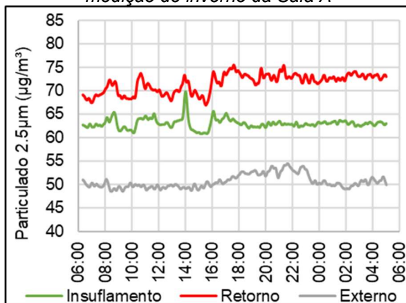
Gráfico 47 - Particulados no terceiro dia de medição de inverno da Sala A
