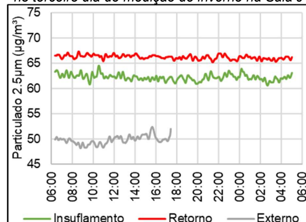
Gráfico 122 - Concentração de particulado 2,5 \mu m no terceiro dia de medição de inverno na Sala J
