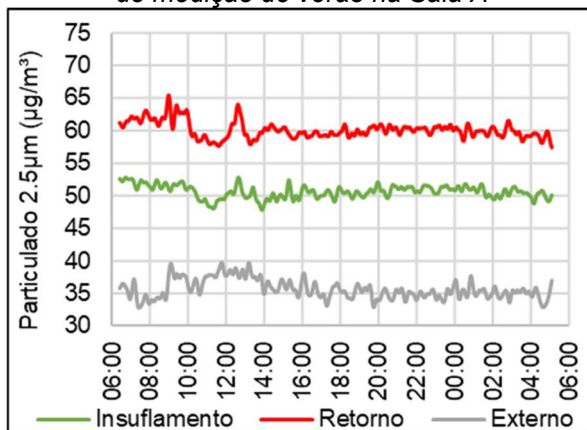
Gráfico 66 - Particulados 2.5 \mu m no primeiro dia de medição de verão na Sala A
