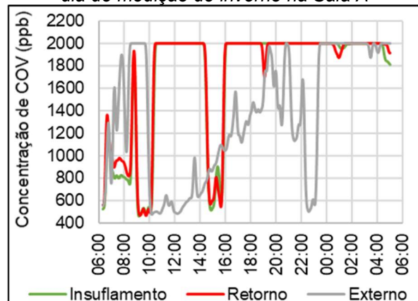
Gráfico 44 - Concentrações de COV no terceiro dia de medição de inverno na Sala A
