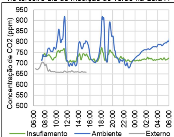
Gráfico 65 - Concentração de dióxido de carbono no terceiro dia de medição de verão na Sala A
