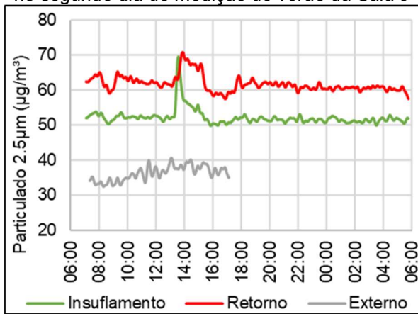
Gráfico 139 - Concentração de particulado 2,5µm no segundo dia de medição de verão da Sala J
