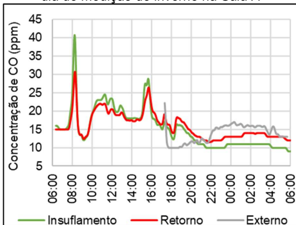
Gráfico 41 - Concentrações de CO no segundo dia de medição de inverno na Sala A
