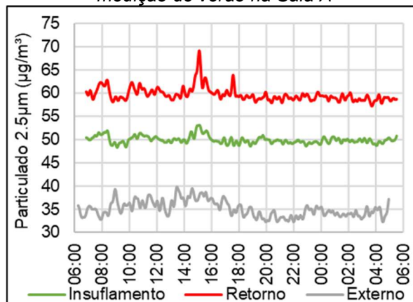
Gráfico 67 - Particulado 2.5 \mu m no segundo dia de medição de verão na Sala A
