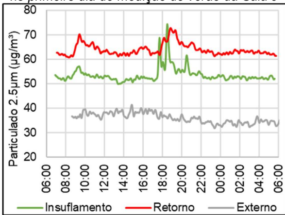
Gráfico 138 - Concentração de particulado 2,5µm no primeiro dia de medição de verão da Sala J
