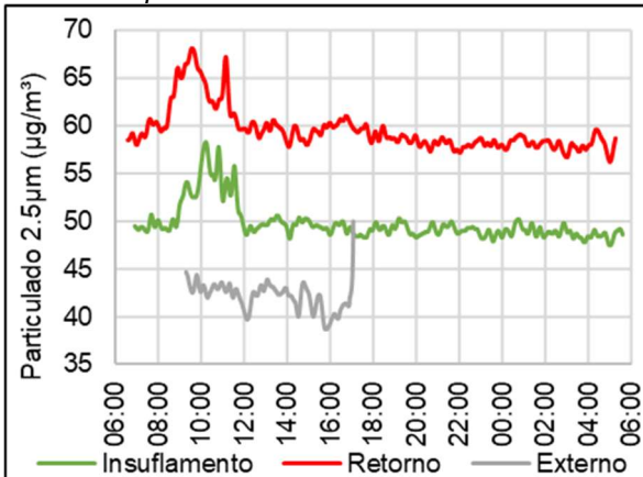
Gráfico 104 - Concentração de particulado 2.5 \mu m no primeiro dia de verão na Sala F
