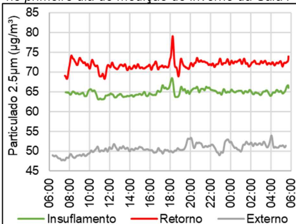
Gráfico 84 - Concentração de particulado 2,5\mu\text{m} no primeiro dia de medição de inverno da Sala F
