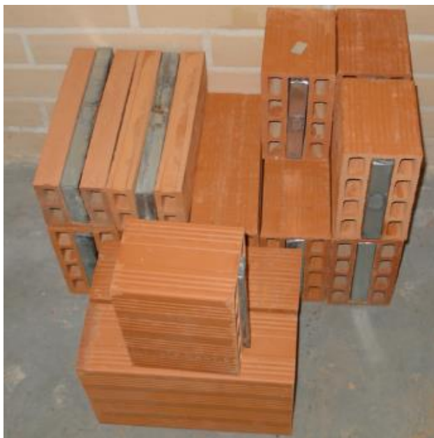
Figura 7 – Tijolos cerâmicos com incorporação direta de MMF
