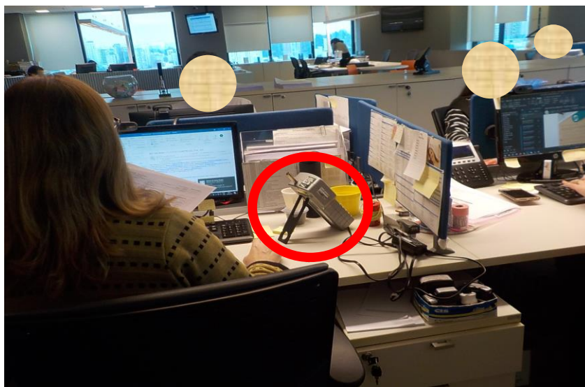
Figura 5.4.2-3 – Posicionamento do contador de partículas
