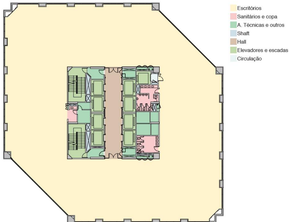
Figura 5.1-1 – Disposição da laje tipo
