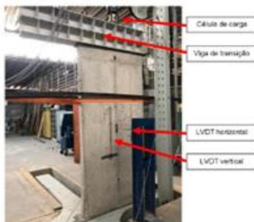
Figura 3 – Exemplos instrumentados para a realização do ensaio
