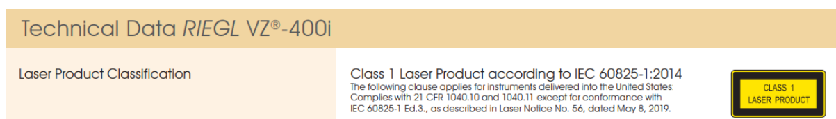
Figura 7 – Indicação da classe de segurança no catálogo do escâner RIEGL 400i, classe 1 Fonte: Extraído de RIEGL Laser Measurement Systems (2023)
