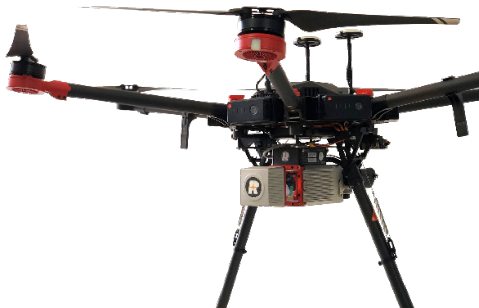
Figura 40 – Drone DJI modelo Matrice 600 Pro com o escâner MiniVux da RIEGL. O mesmo modelo foi utilizado em Paulo Afonso IV.
