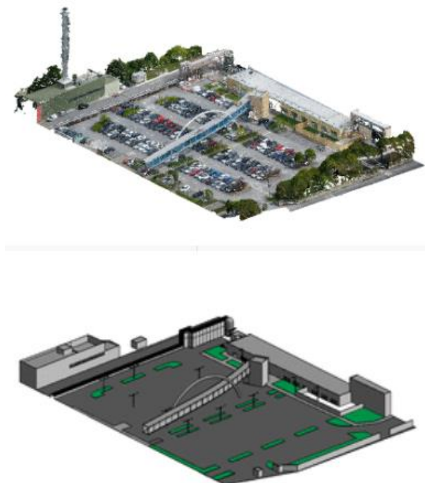
Figura 3 – Nuvem de pontos e modelo BIM
