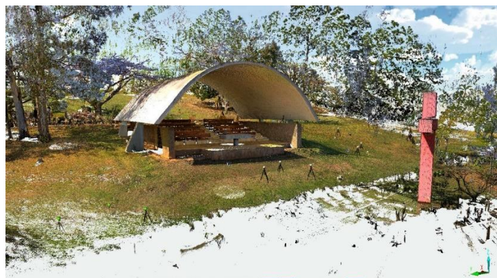
Figura 2 – Nuvem de pontos da Capela da Fazenda Veneza (Valinhos – SP) visualizada no software de registro Faro Scene
