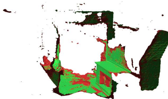
Figura 36 – Fotogrametria terrestre – Casa em Sorocaba – Paredes externas – Vista traseira do modelo de confiabilidade gerado após processamento de fotogrametria pela ferramenta Agisoft Metashape.
