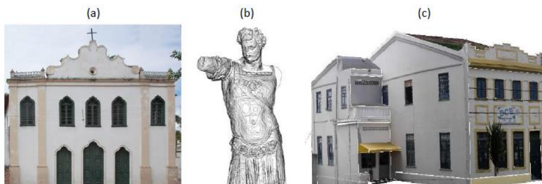
Figura 8 – Exemplos de produtos obtidos das tomadas fotográficas em diferentes situações (quantidade de fotos e posição das tomadas) – (a) monorrestituição, (b) estereorrestituição e (c) restituição com múltiplas fotos.
