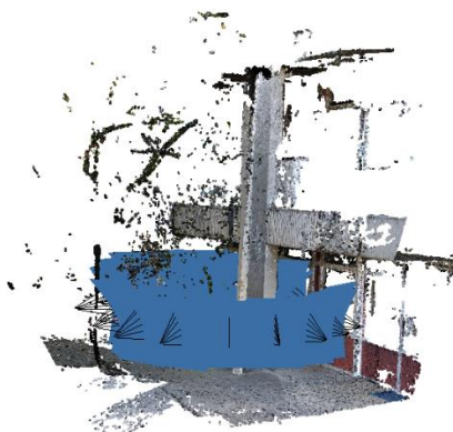
Figura 86 – Fotogrametria terrestre – Pilar da Poli-USP – Locais de captura fotográfica indicadas em azul.
