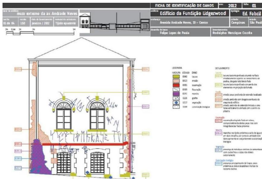
Figura 27 – Exemplo de mapa de danos em fachada elaborado em AutoCad
