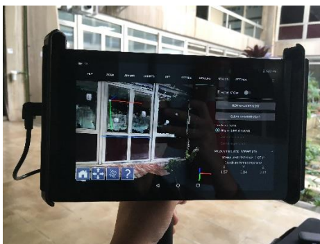
Figura 140 – Escâner de mão – Fachada externa de sala de aula da Eng. Civil da USP – Foto da captura com escâner de mão em campo.
