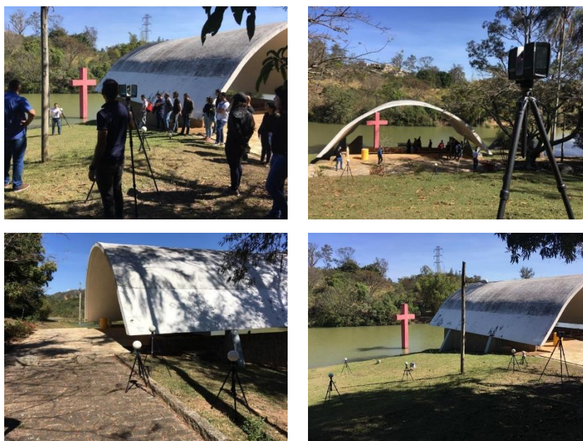
Figura 123 – Escâner a laser – Capela da Fazenda Veneza – Fotos das capturas com escâner a laser em campo.
