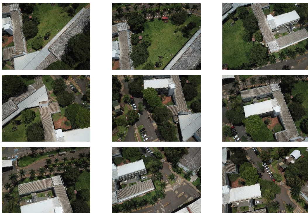
Figura 115 – Fotogrametria aérea – Cobertura do IAU São Carlos – Amostra de fotos capturadas em campo para processamento no Agisoft Metashape.
