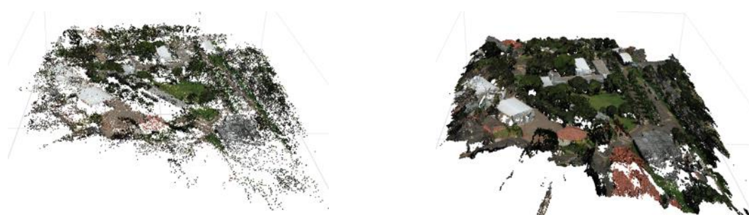
Figura 118 – Fotogrametria aérea – Cobertura do IAU São Carlos – Vista do modelo gerado após processamento de fotogrametria pela ferramenta Agisoft Metashape.
