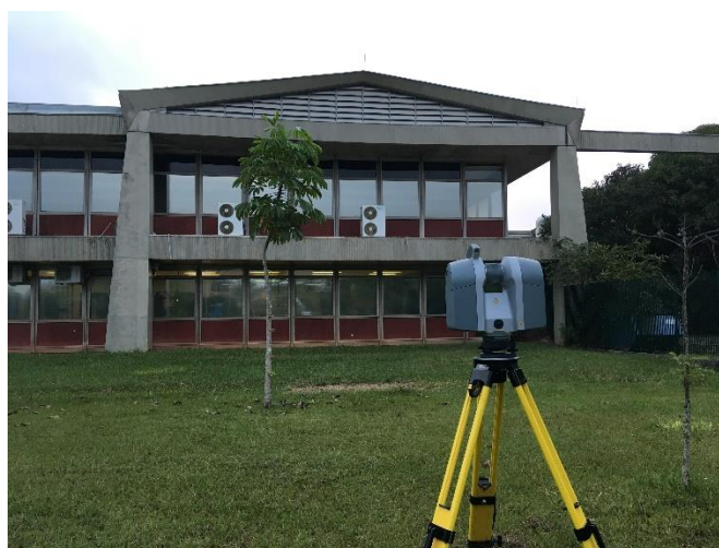
Figura 1 – Escâner a laser da Trimble em fase de captura do Edifício da Engenharia Civil da USP (São Paulo – SP)
