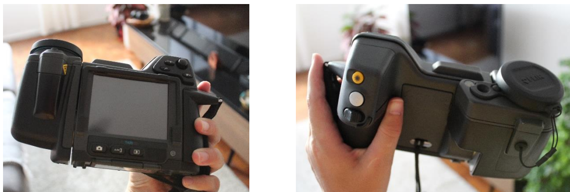
Figura 144 – Câmera térmica Flir
