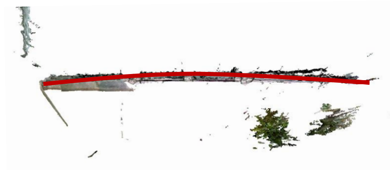
Figura 143 – Escâner de mão – Fachada externa de sala de aula da Eng. Civil da USP – Visualização superior (planta) da nuvem de pontos no programa Autodesk Recap.
