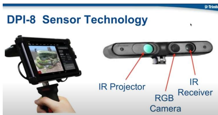
Figura 136 – Escâner de mão DPI-8 da Trimble – elementos de captura de dados.
