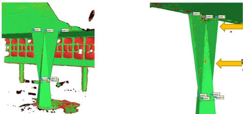
Figura 63 – Fotogrametria terrestre – Pilar da FAU-USP – Vista oblíqua frontal e vista oblíqua de trás, do modelo de confiabilidade gerado após processamento de fotogrametria pela ferramenta Agisoft Metashape.
