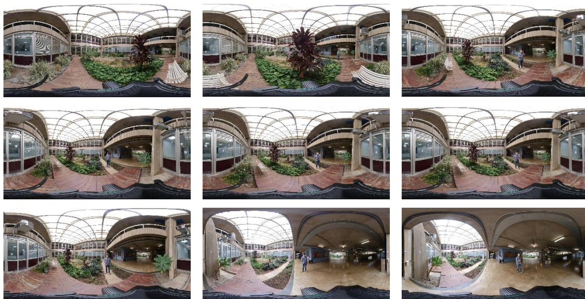
Figura 110 – Fotogrametria com câmera 360° – Área externa da sala de aula da Eng. Civil da USP – Amostra de fotos capturadas em campo para processamento no Agisoft Metashape e modelagem no Autodesk Revit.
