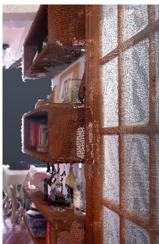
Figura 138 – Escâner de mão – Estante – Visualização da nuvem de pontos no programa Autodesk Recap.
