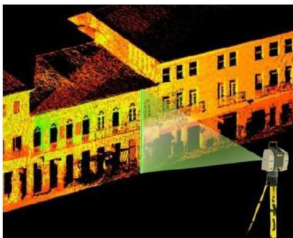
Figura 6 – Representação esquemática do escâner a laser terrestre
