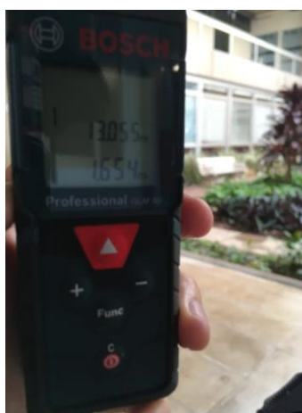
Figura 141 – Escâner de mão – Fachada externa de sala de aula da Eng. Civil da USP – Medição com trena laser .
