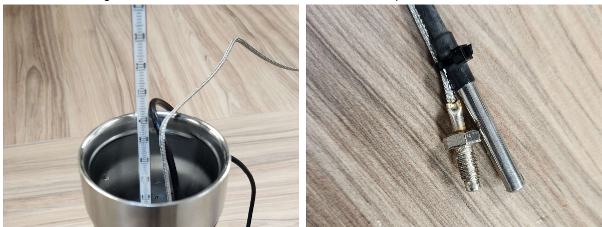
Figura A. 1 – Posicionamento dos sensores de temperatura avaliados
