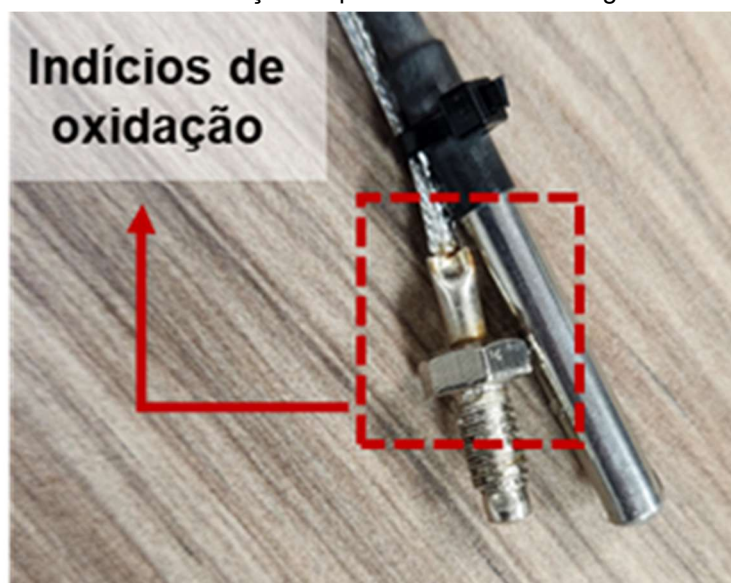
Figura A. 2 – Indícios de oxidação na ponta do sensor analógico de temperatura
