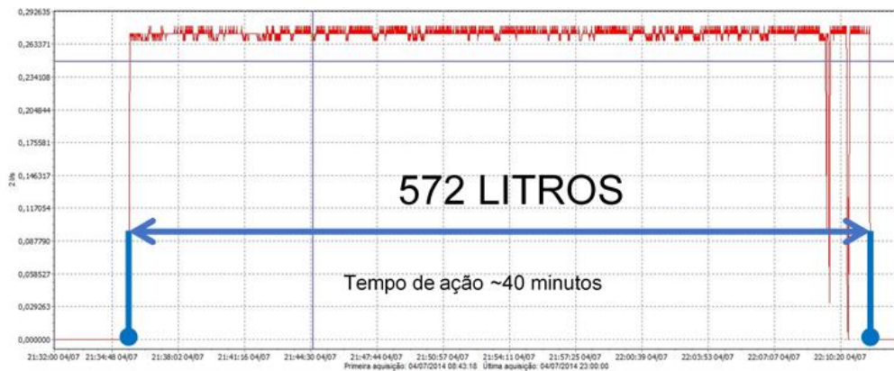
Figura 5.67 - Vazamento em aparelho sanitário
