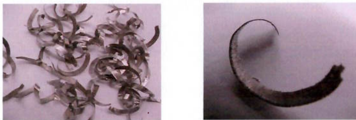
Figura 4.1.1.70 – Cavaco do ensaio 31. V_c = 45 m/min, f_z = 0,065 mm/faca - concordante.
