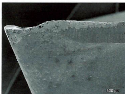
Figura 4.1.1.43 – Microscopia eletrônica do desgaste no ensaio 29 (40X).
