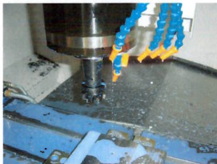
Figura 3.6.1.2 – Fixação do cone básico no eixo árvore da máquina.
