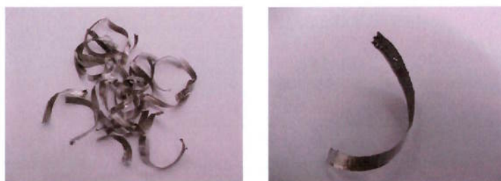
Figura 4.1.1.63 – Cavaco do ensaio 7. V_c = 45\text{ m/min} , f_z = 0,065\text{ mm/faca} - discordante.
