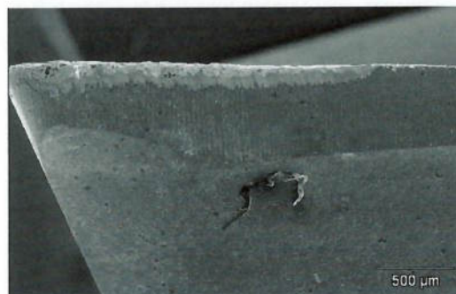
Figura 4.1.1.48 – Microscopia eletrônica do desgaste no ensaio 29 (40X).
