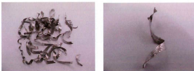
Figura 4.1.1.64 – Cavaco do ensaio 15. V_c = 45 m/min, f_z = 0,065 mm/faca - discordante.
