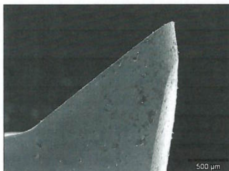
Figura 3.5.2.2 – Microscopia eletrônica da pastilha APCR nova. Detalhe da superfície de folga secundária e do ângulo de saída radial. (40X)
