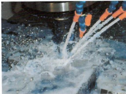
Figura 3.7.1.1. Ilustração da disposição dos bicos de refrigeração.
