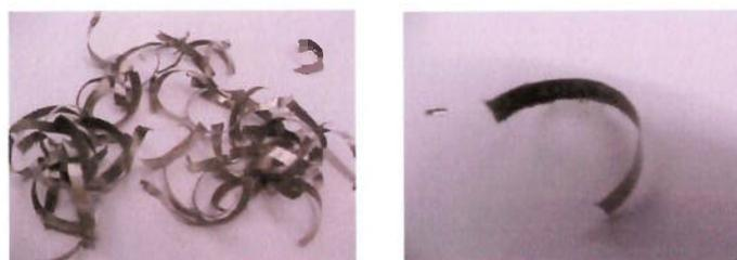
Figura 4.1.1.68 – Cavaco do ensaio 19.  $V_c = 45$  m/min,  $f_z = 0,065$  mm/faca - concordante.
