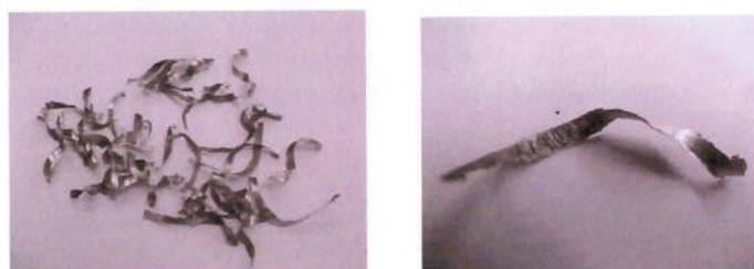
Figura 4.1.1.66 – Cavaco do ensaio 1.  $V_c = 30$  m/min,  $f_z = 0,065$  mm/faca - discordante.
