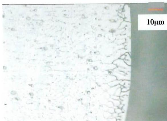
Figura 3.2.2 - Micrografia da seção transversal do corpo de prova. O trecho a direita da figura é o metal de base que foi consumido pela solução de 100ml de HF com 100ml de HNO<sub>3</sub>. O tempo de imersão na solução foi de 5 minutos. A diferença de nitidez da região a direita é devido à diferença de plano proporcionada pela notável corrosão sofrida pelo metal de base.
