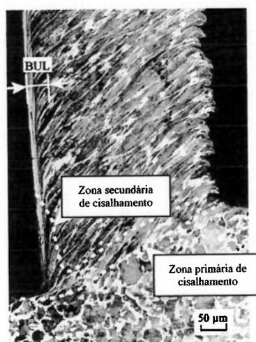
Figura 2.2.2.4 – Zonas de deformação na raiz do cavaco durante sua formação, conforme Jaspers et al. [27].
