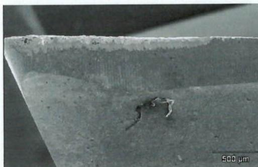
Figura 4.1.1.48 – Microscopia eletrônica do desgaste no ensaio 29 (40X).
