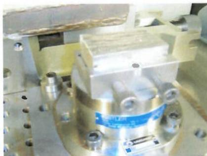
Figura 3.6.2.2 – Fixação do dispositivo de fixação do corpo de prova sobre o dinamômetro e do corpo de prova no dispositivo de fixação.
