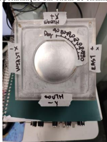
Figura 3.8 - (-a-) Posições Norte, Sul, Leste e Oeste, assim como os ângulos de 0° até 90° definidos para verificação da polarização das ondas de cisalhamento. (-b-) Transdutor de cisalhamento fixado com pasta.
