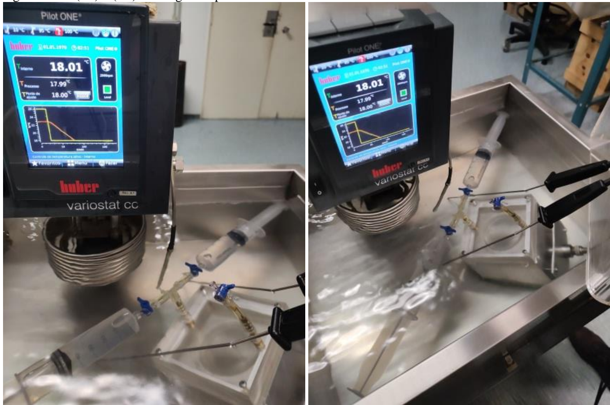
Figura 3.13 - (-a-) e (-b-) Montagem experimental utilizada com a célula US-CMI imersa no banho termostático.
