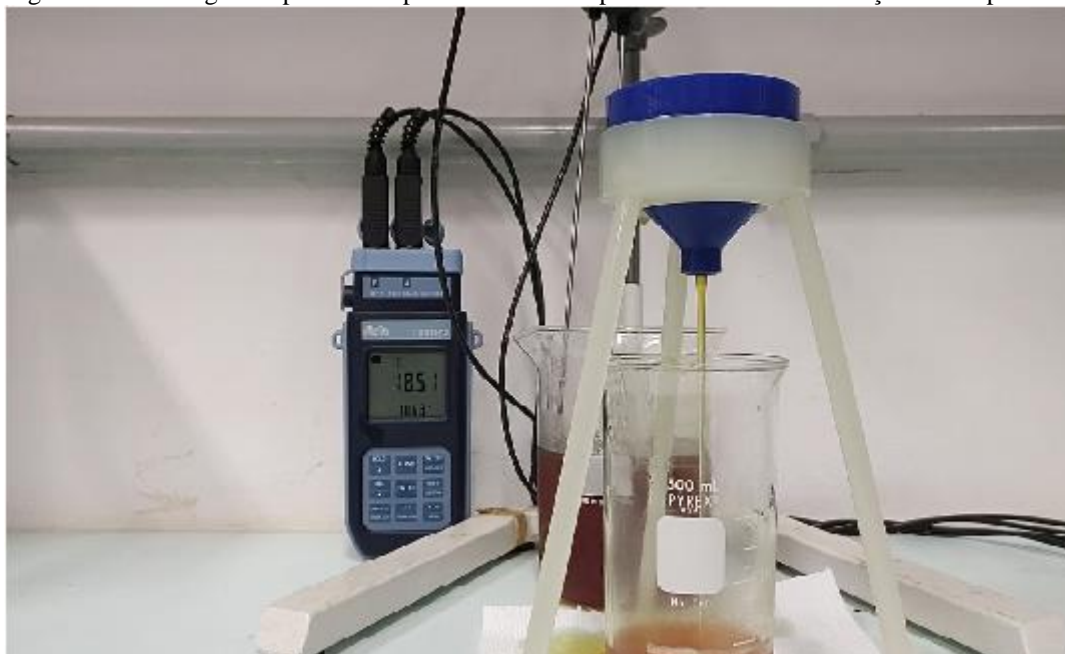
Figura B.1- Montagem experimental para coleta do tempo de escoamento em função da temperatura
