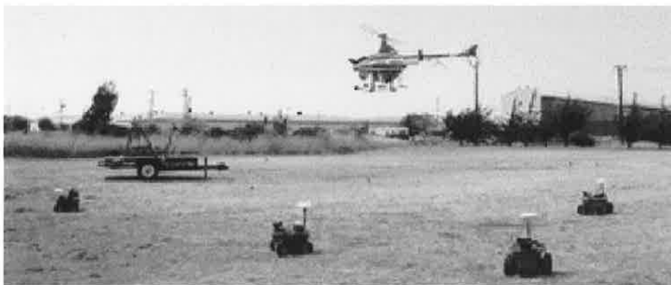
Figura 11-33: Berkeley RUAV (Rotorcraft UAV) em um voo autônomo com robôs de terra.
