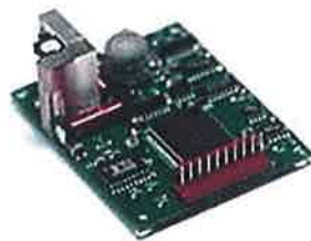
Figura 3-7: CPS (Roll, Pitch, Yaw e Campo Magnético).
