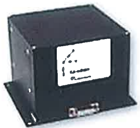
Figura 3-6: IMU (atitude (Pitch e Roll), taxa de rotação e aceleração).
