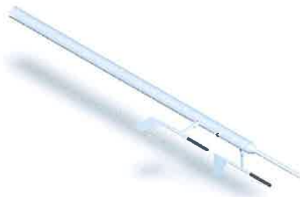
Figura 3-8: ADB (ângulos de ataque e side-slip, temperatura, umidade e pressão atmosférica e velocidade do ar).
