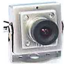
Figura 3-9: VVF (responsável por simular por meio de câmeras solidárias à aeronave a visão do piloto se este estivesse a bordo, com o objetivo de permitir voo VFR).
