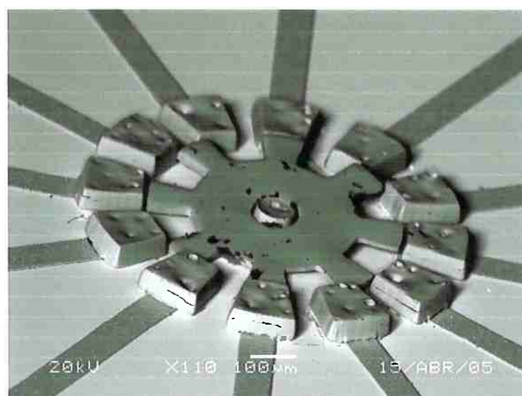
Figura 158 - Foto de microscópio eletrônico da montagem do estator s451520 e rotor r301020.
