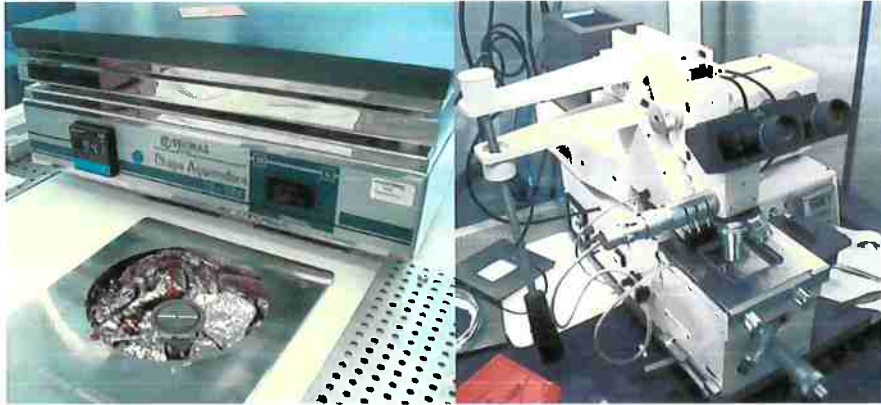
Figura 142 - Equipamentos usados no LNLS para deposição do molde de resiste.
