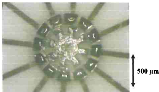
Figura 153 - Foto da estrutura final do micromotor no caso de estator s501020se e rotor r401520.
