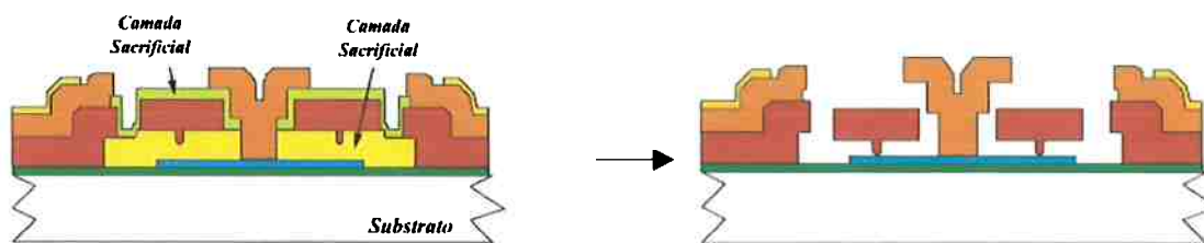
Figura 6 – Exemplo de Micro-usinagem de superfície.
