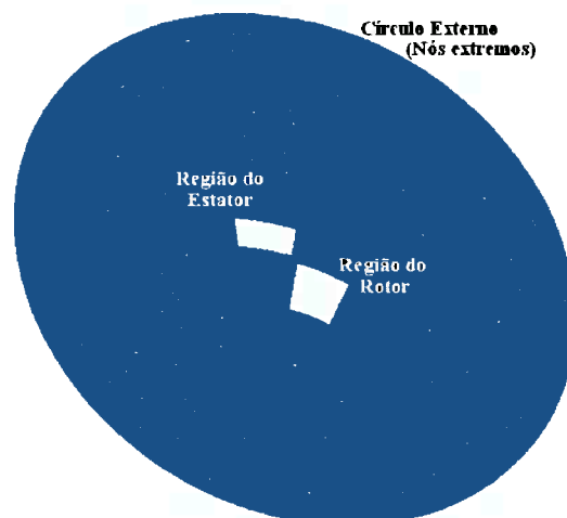
Figura 44 - Um modelo de MEF tridimensional com desalinhamento máximo.
