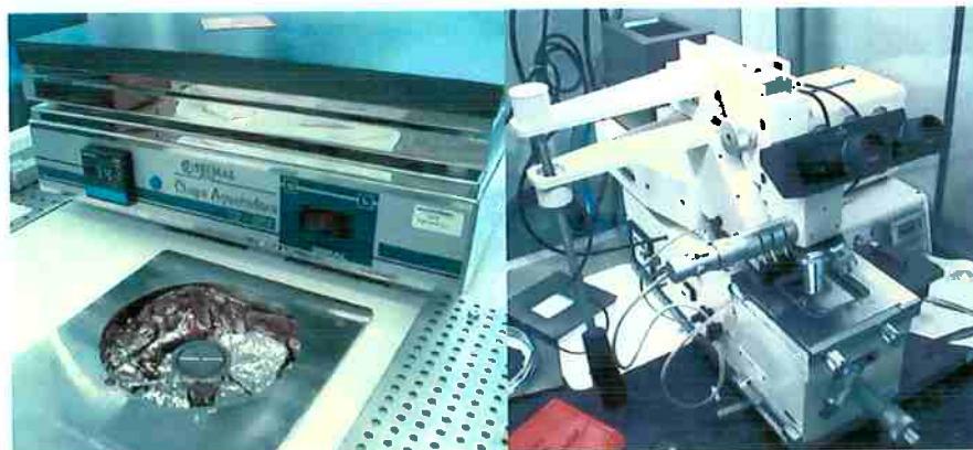
Figura 142 - Equipamentos usados no LNLS para deposição do molde de resiste.
