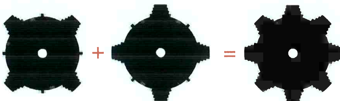
Figura 183 - Montagem de um rotor com 8 dentes a partir do modelo otimizado com 70% de volume.
