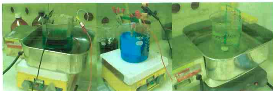
Figura 143 - Equipamentos usados no LNLS para eletrodeposição das estruturas metálicas do micromotor.
