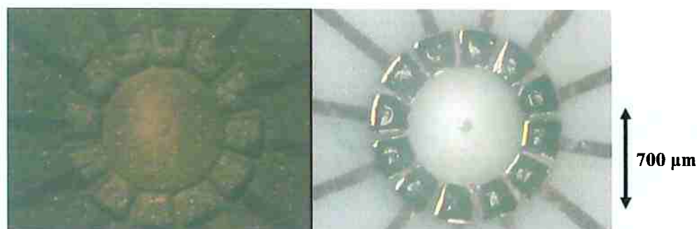
Figura 150 - Fabricação do protótipo de estator s702525: à esquerda, o molde e resiste e, à direita, a estrutura de Níquel finalizada sobre a trilha elétrica.
