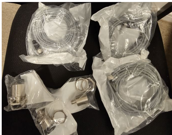
Figura 64 – Sensores de distância com cabos
