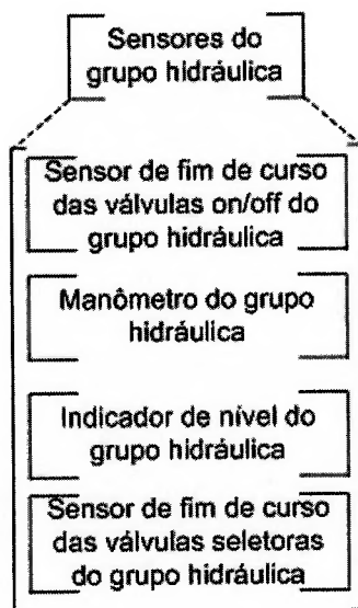
Figura B. 11 – Detalhamento da atividade [Sensores do grupo hidráulica].
