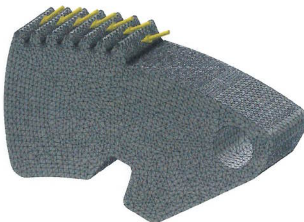
Figura 4.21: Análise do Elemento de acoplagem – Malha e forças aplicadas.
