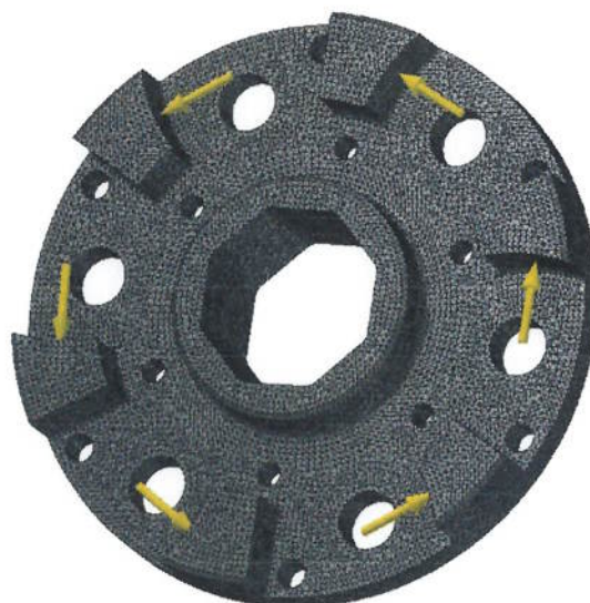
Figura 4.19: Análise da Gaiola – Malha e forças aplicadas.
