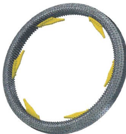
Figura 4.22: Análise do Anel externo – Malha e forças aplicadas.
