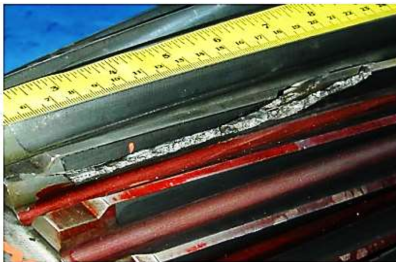
Figura 77 – Quebra do dente no pinhão da baixa rotação.
