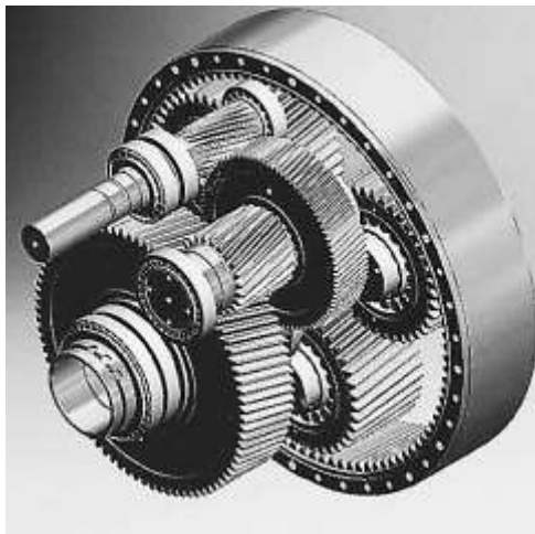
Figura 41 – Modelo geométrico da transmissão NREL 750 kW com os dentes das engrenagens.
