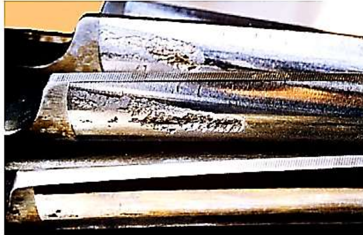
Figura 75 – Representação do macro-pitting na coroa da baixa rotação.
