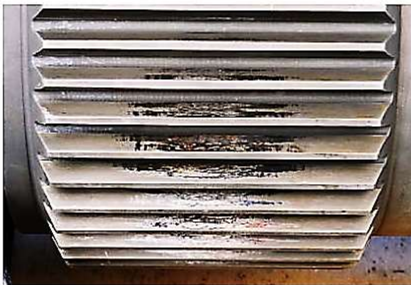
Figura 74 – Representação do fretting na engrenagem solar.
