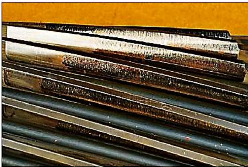
Figura 73 – Representação do scuffing no pinhão da alta rotação.
